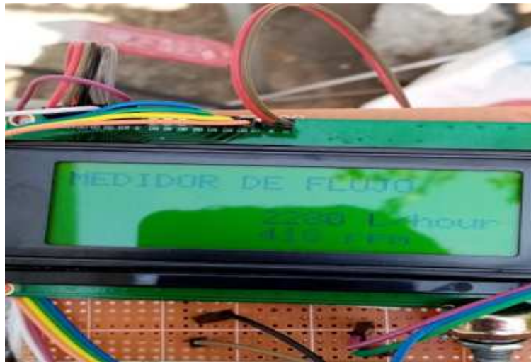
Figura 46. Medicion de flujo de gas y velocidad en rpm
