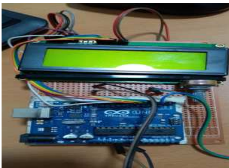
Figura 44. Circuito para medicion de flujo de gas y oxigeno
