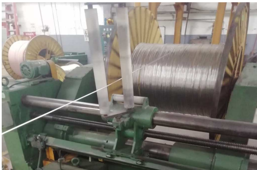
Figura 2.13: Devanador o distribuidor. Obtenido: Ecuacable S.A.
