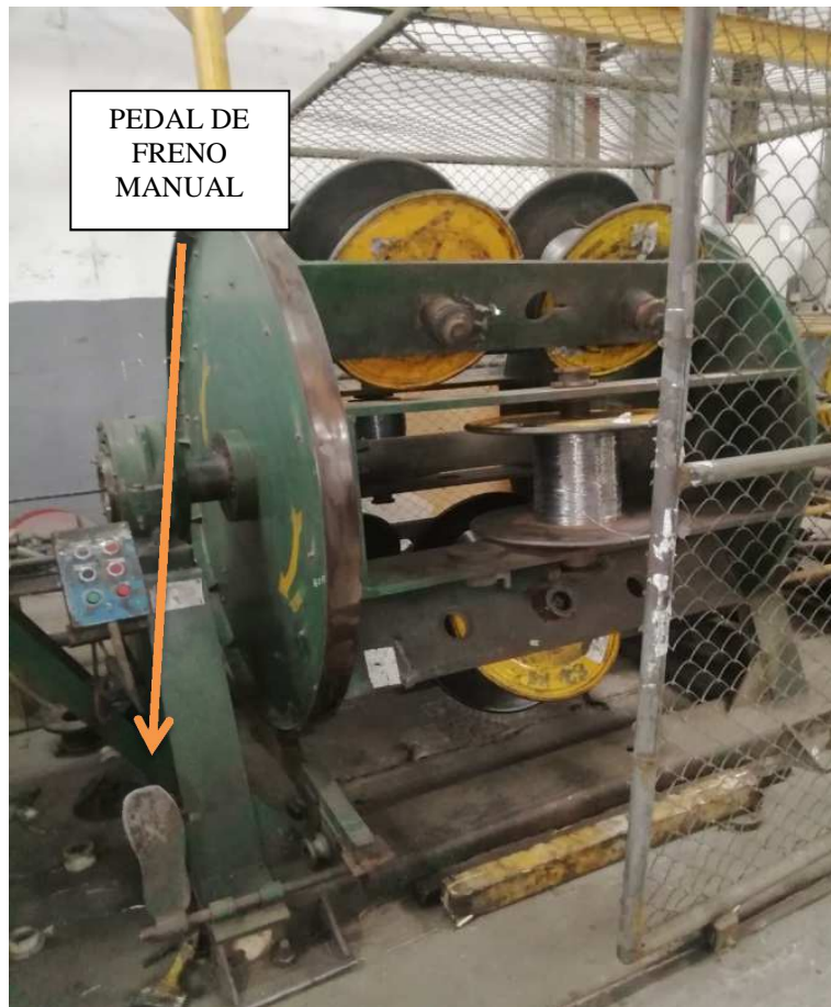
Figura 3.45: Tambor de Cableadora. Obtenido: Ecuacable S.A.
