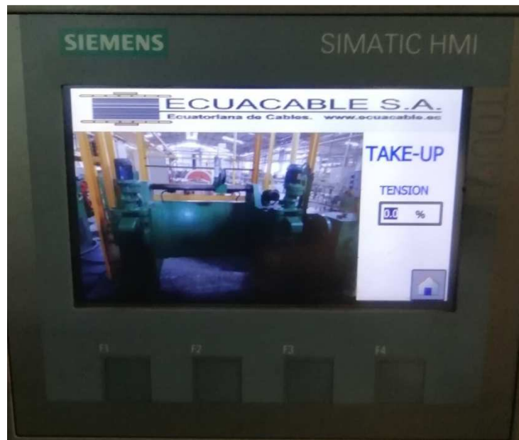
Figura 4.63: Pantalla de regulacion de torque take up Obtenido: Ecuacable S.A.
