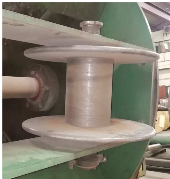
Figura 3.44: Bobina ajustada en tambor de Cableadora. Obtenido: Ecuacable S.A.
