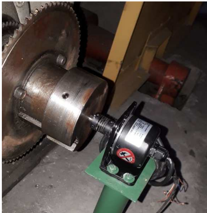
Figura 4.65: Encoder Autonics 120 ppr. Obtenido: Ecuacable S.A.
