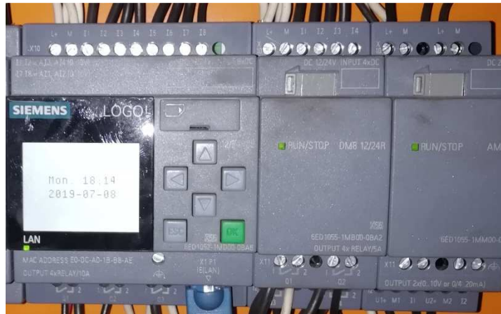
Figura 4.54: Logo con módulo de expansión. Obtenido: Ecuacable S.A.
