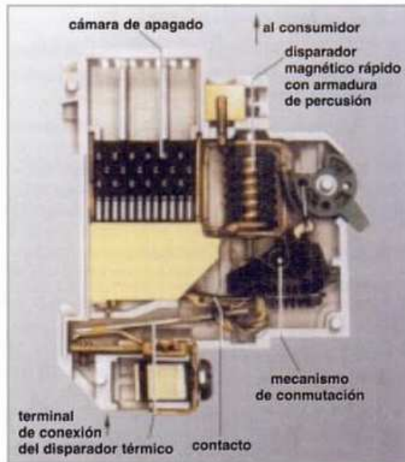
Figura 2.26: Estructura de interruptor magnetotérmicos. Obtenido: Electrotecnia. (Bastian, 2001)
