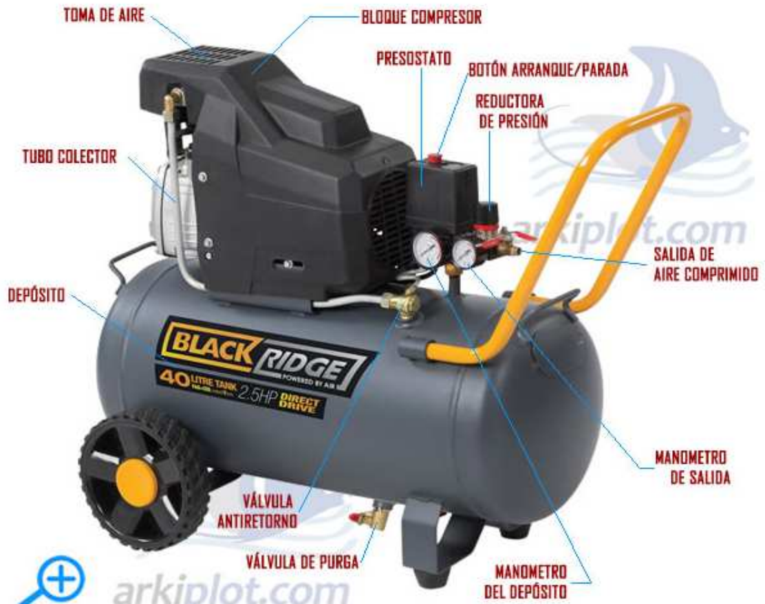
Figura 2.37: Compresor de aire comprimido Obtenido: («Pierdele el miedo a la neumática») 2017.
