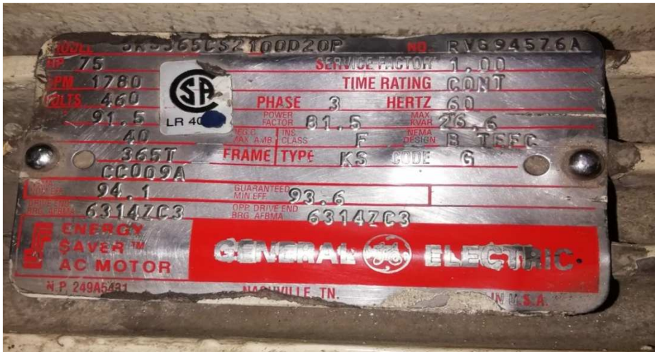
Figura 3.50: Placa de características motor principal Obtenido: Ecuacable S.A.
