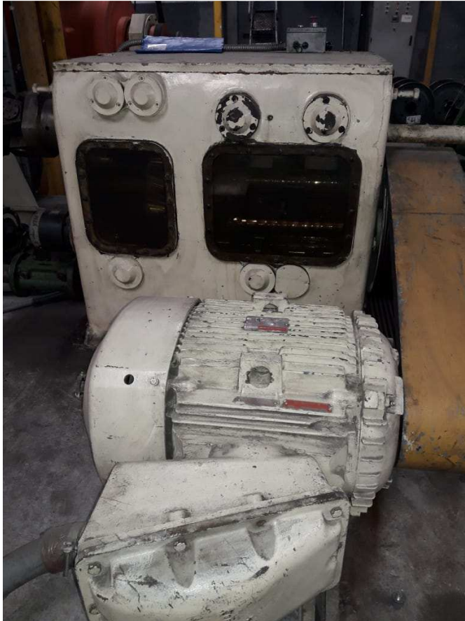
Figura 4.59: Motor principal con caja de cambio de velocidades para paso de torsión. Obtenido: Ecuacable S.A.
