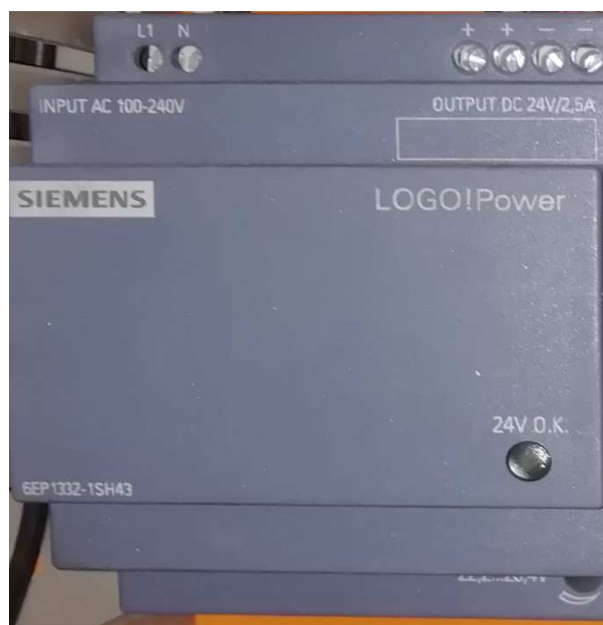
Figura 4.55: Fuente de voltaje 24VDC. Obtenido: Ecuacable S.A.
