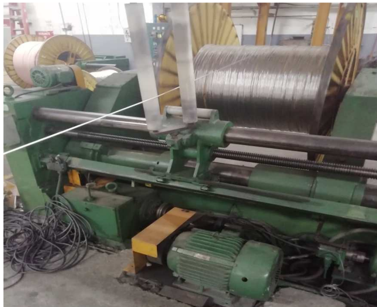
Figura 4.60: Motor de take up o bobinador. Obtenido: Ecuacable S.A.
