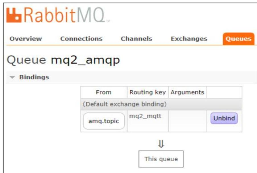
Figura 3.49 Verificación del intercambio con el enlace de la cola.
