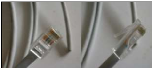
Figura 4. 12: Ingreso del cable al conector RJ-45. Fuente: Autor
