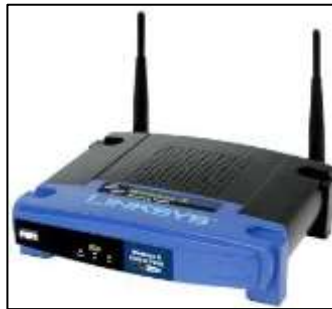
Figura 2. 15: Access Point Fuente: (Cisco, 2015)
