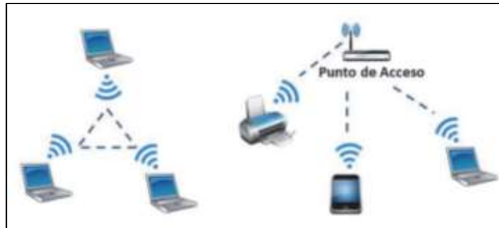
Figura 2. 3: Con junto de servicios básicos (BSS) e Independiente (IBSS). Fuente: (Salazar, 2015)
