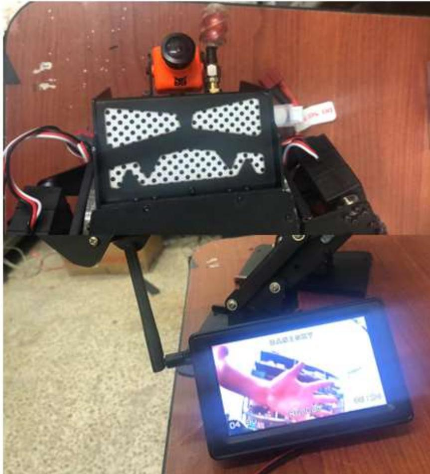
Figura 3. 49: Prueba de caminado con visión remota.
