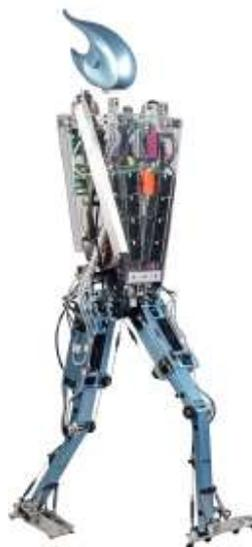
Figura 2. 7: Robot humanoide avanzado “FLAME”.
