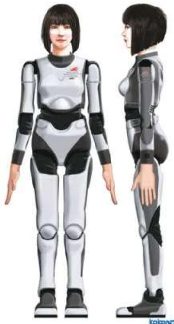
Figura 2. 5: Robot humanoide avanzado HRP-4C.
