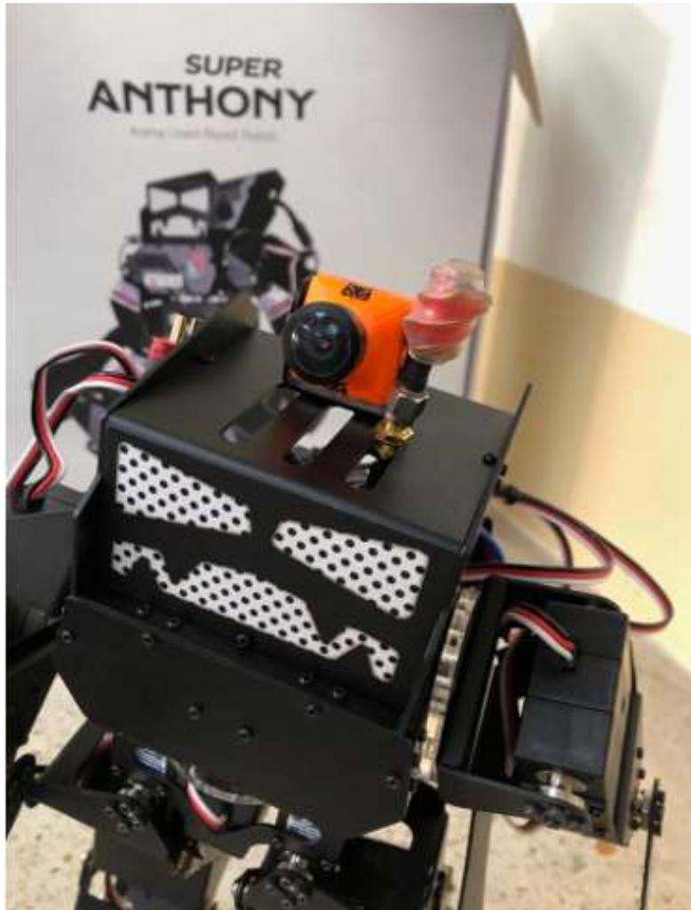
Figura 3. 48: Montaje de cámara en robot super anthony.
