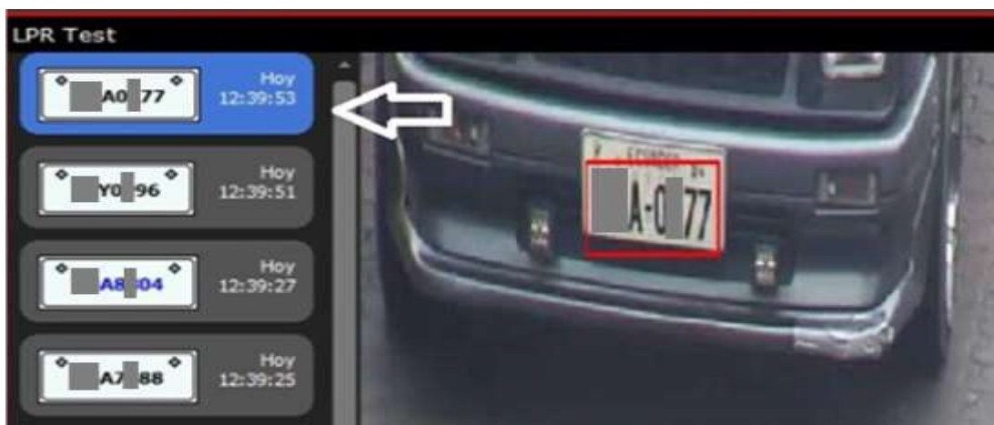
Figura 3.22: Validación lectura placas vehiculares Elaborado por: Autor
