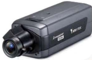
Figura 2. 9: Cámara Fija Tipo Caja (Box) Fuente: (Mata, 2010)
