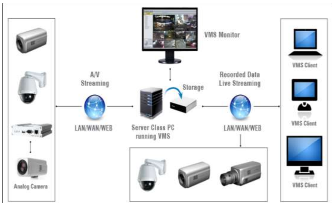
Figura 2. 3: Diagrama de conexión VMS. Fuente: (Marshall Electronics, 2019)
