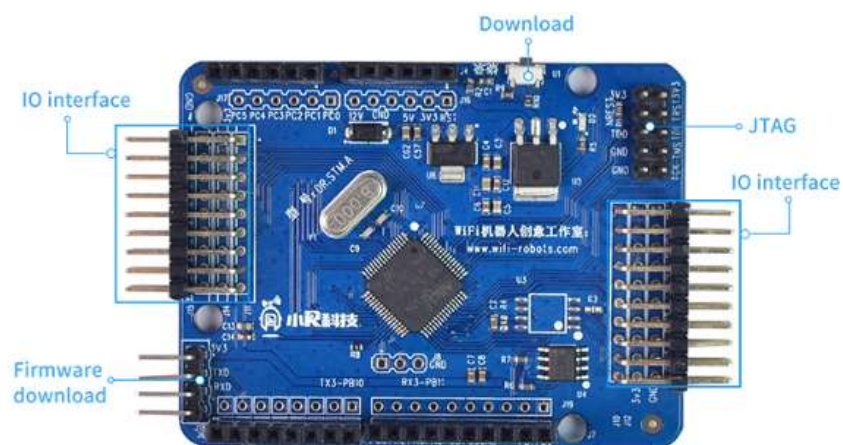
Figura 3. 3: Tarjeta Stm32F105 Elaborado por: Autor.
