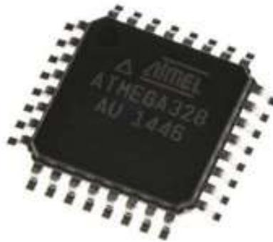
Figura 3. 3: Microcontrolador ATMEGA 328p.
