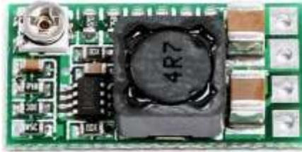
Figura 3. 7: Regulador de voltaje conmutada.
