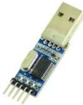
Figura 3. 5: Módulo conversor USB - TTL.
