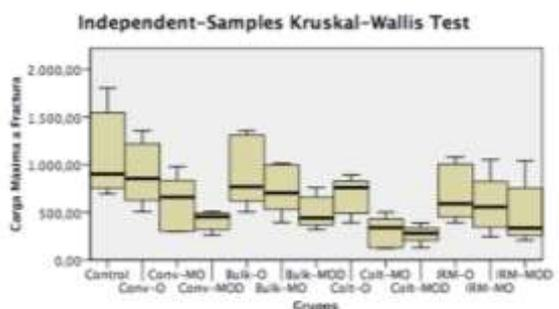
Figura 1. Gráfico representativo de las cargas máximas a fractura de todos los grupos estudiados
