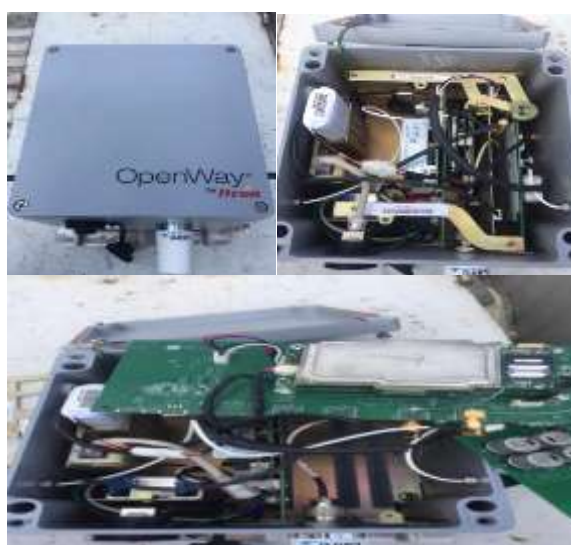
Figura 2.15 Colector Itron Openway visto por fuera y en su interior Fuente: autor
