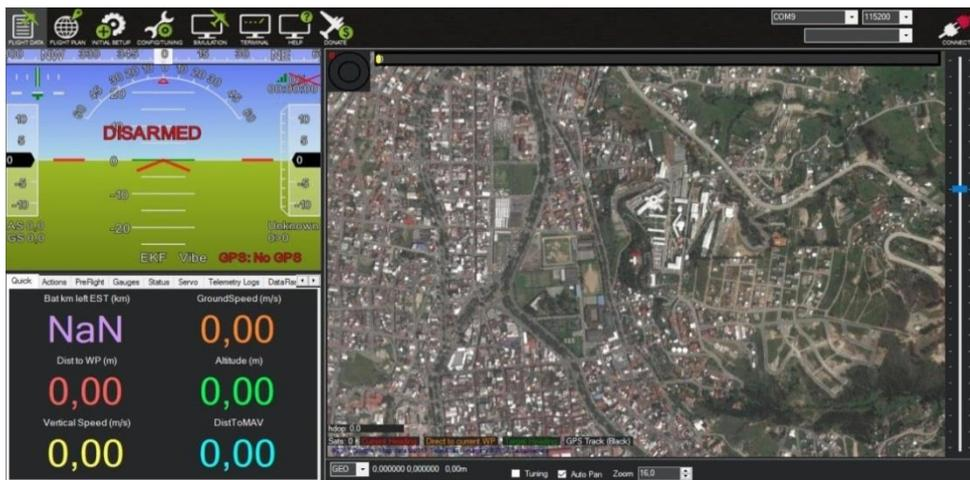
Figura 3.10 Interfaz para el monitoreo del dron
