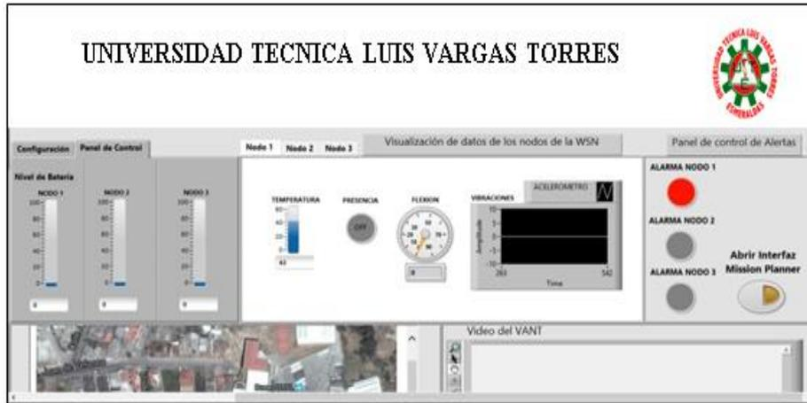
Figura 3.9 Interfaz para el control y monitorización de los nodos de la WSN
