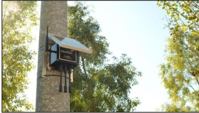
Figura 2.49 Tecnología Wasp mote .Recarga con panel solar
