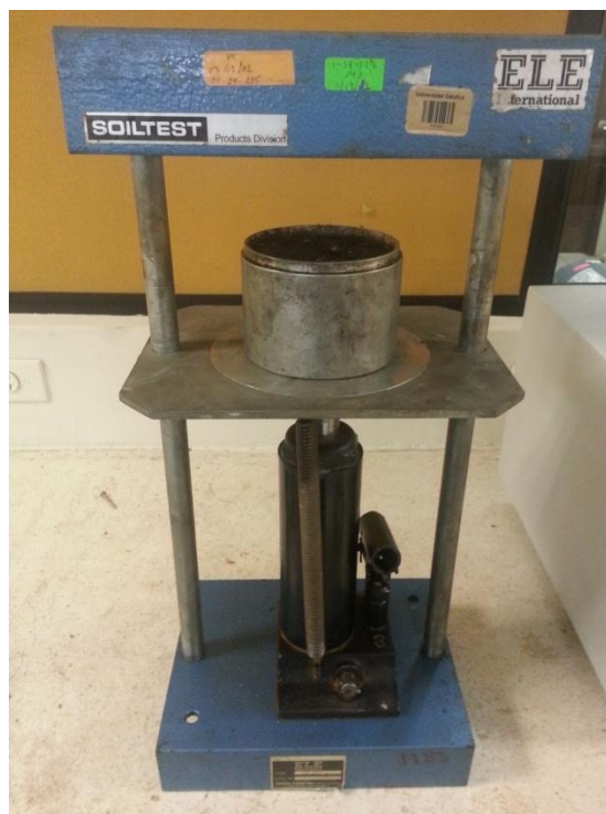
Gráfico 7-22: Molde colocado en el extractor de muestras.
