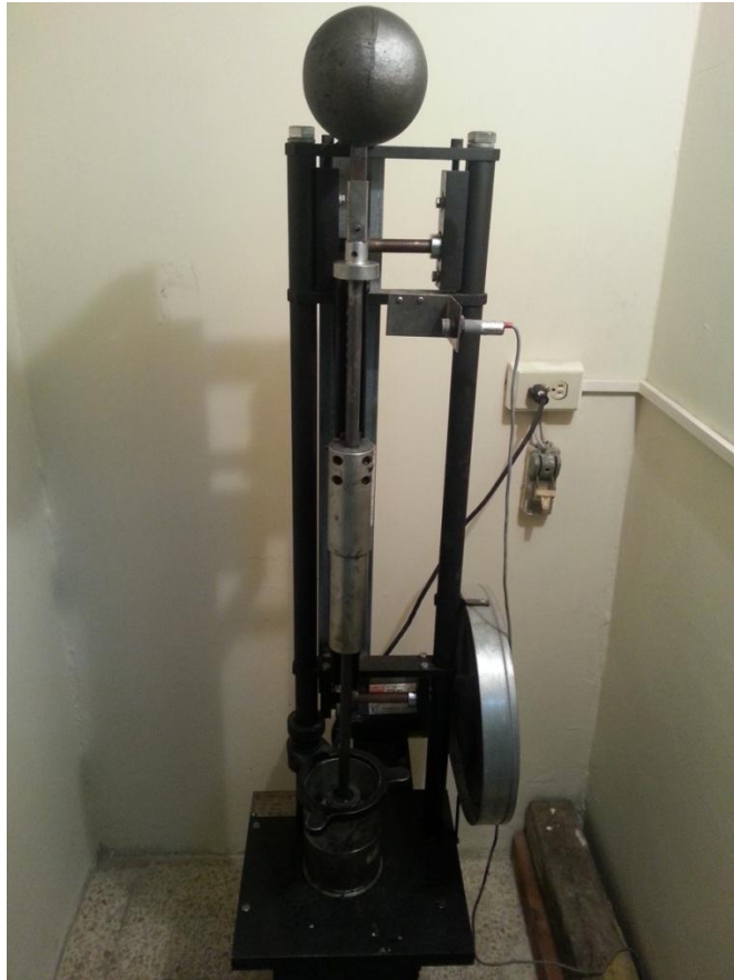
Gráfico 7-20: Compactación tipo Marshall en proceso.
