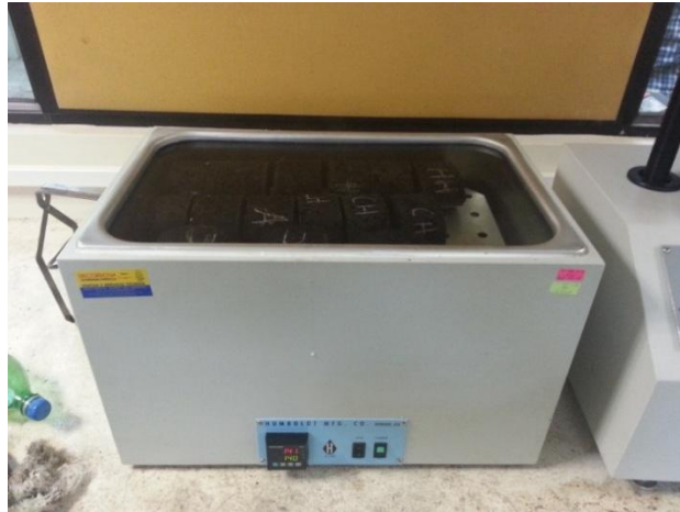
Gráfico 7-26: Briquetas tipo Marshall sumergidas en un baño de agua a 60°C.
