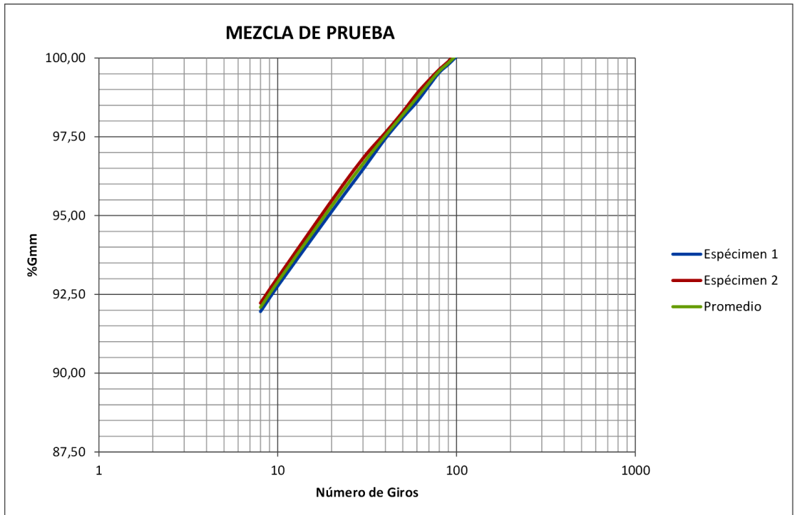
Gráfico 4-4: Curvas de densificación para una mezcla de prueba.
