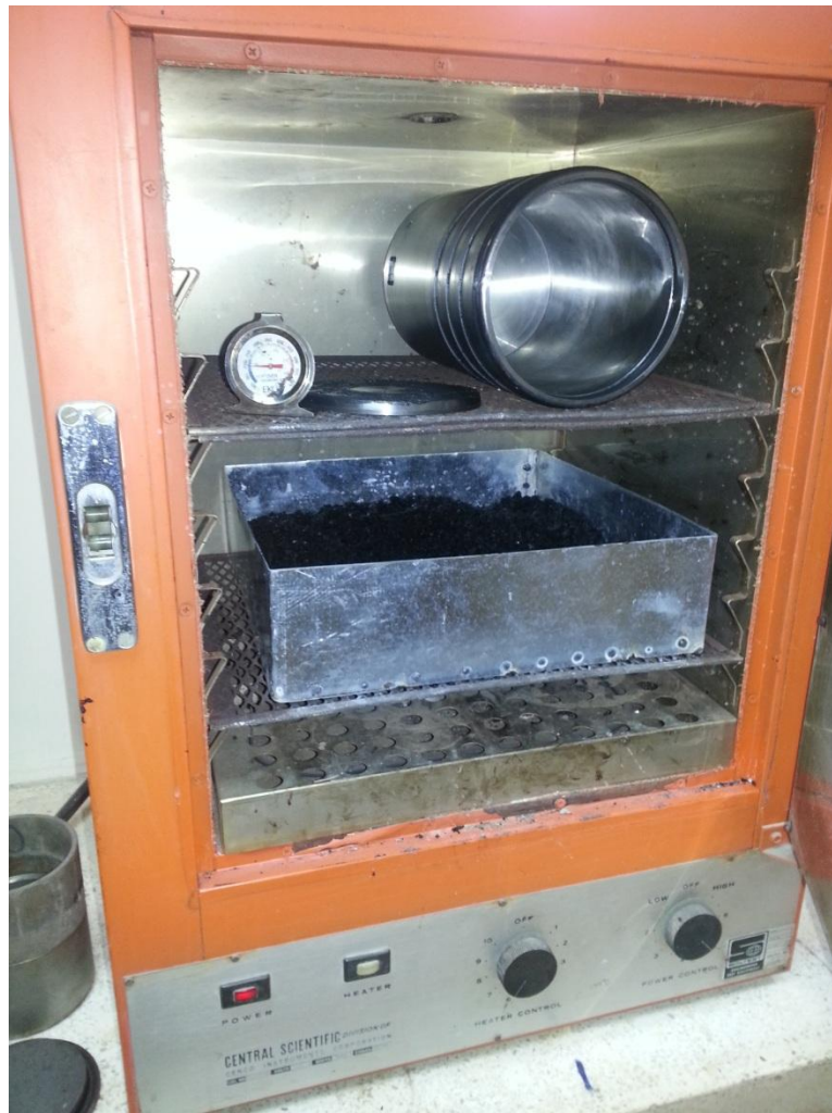
Gráfico 7-3: Bandeja metálica con mezcla, molde y platos de base dentro de horno eléctrico.
