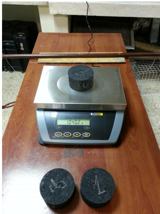
Gráfico 7-23: Balanza electrónica de precisión 0,1 g registrando el Peso Seco.
