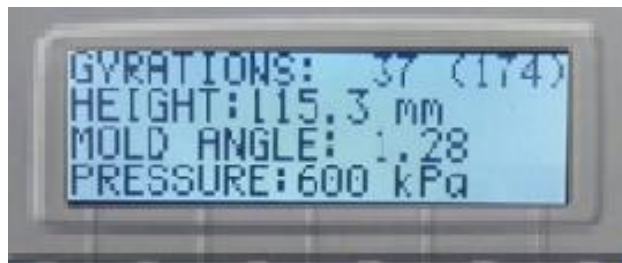
Gráfico 7-11: Parámetros de una compactación en proceso.
