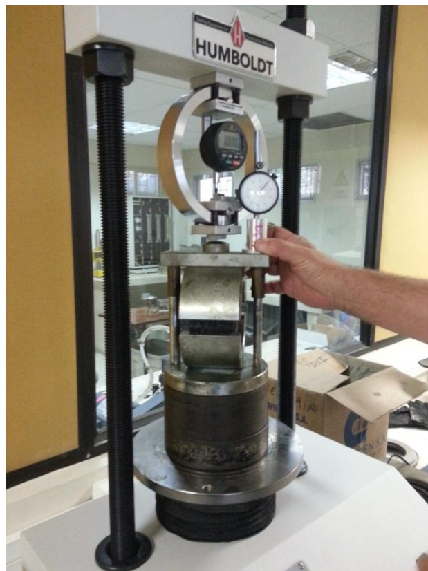
Gráfico 7-27: Briqueta colocada en la prensa electrónica Marshall.
