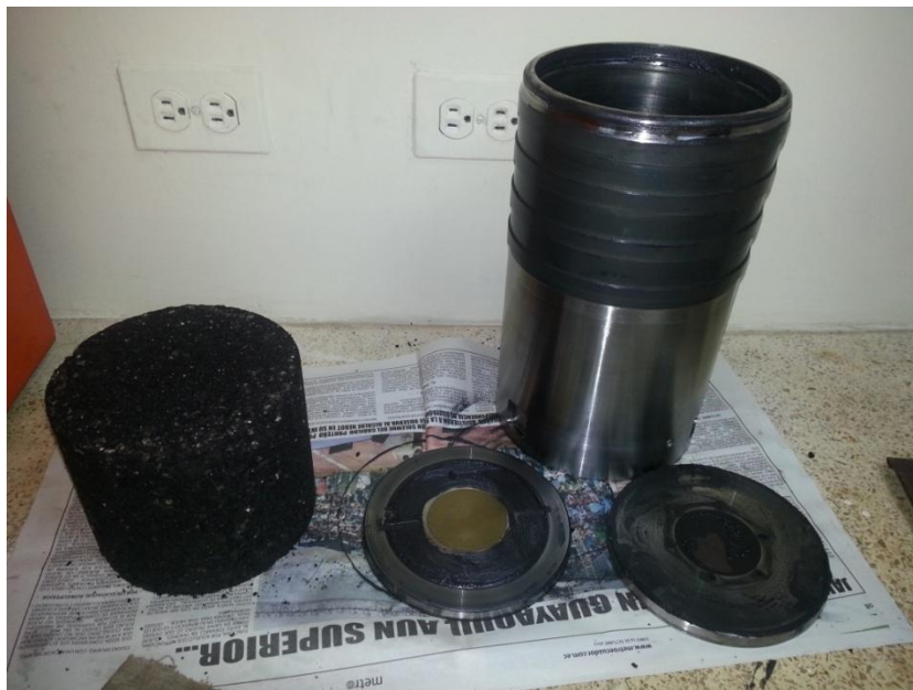
Gráfico 7-16: Molde, platos de base y briqueta después de un ensayo de compactación.
