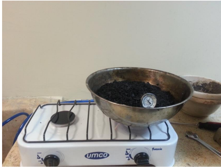
Gráfico 7-18: Mezcla asfáltica siendo recalentada en una cocineta convencional.
