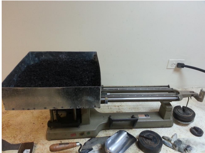
Gráfico 7-2: Bandeja metálica con mezcla asfáltica siendo pesada.
