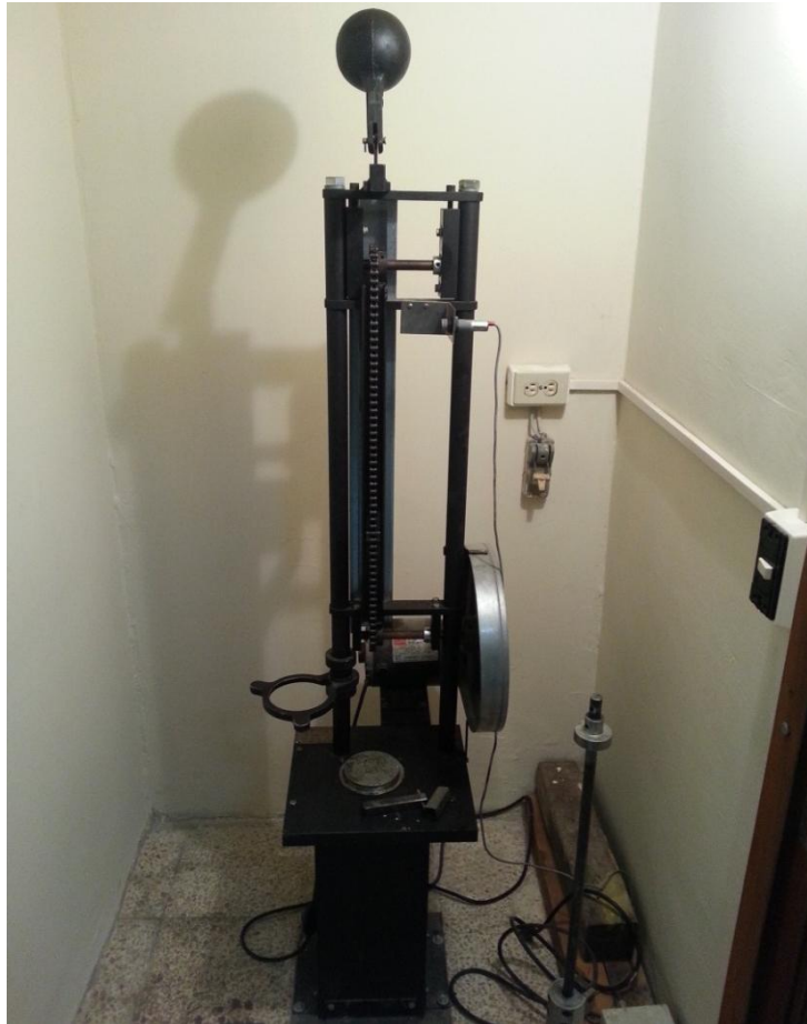
Gráfico 7-19: Compactador electromecánico para el ensayo Marshall.
