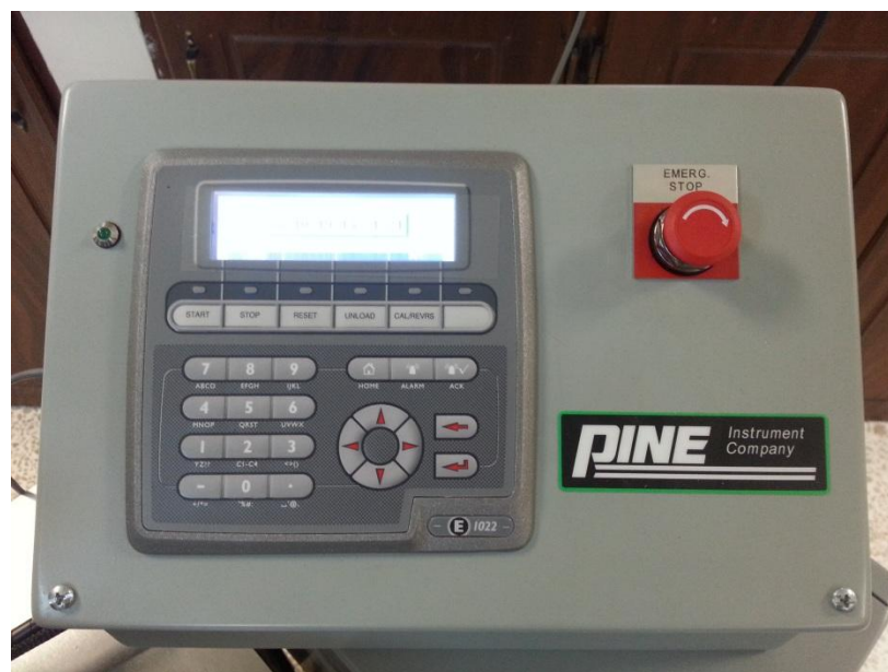
Gráfico 6-4: Botón “Emergency Stop” (rojo) en la consola principal del AFGB1.
