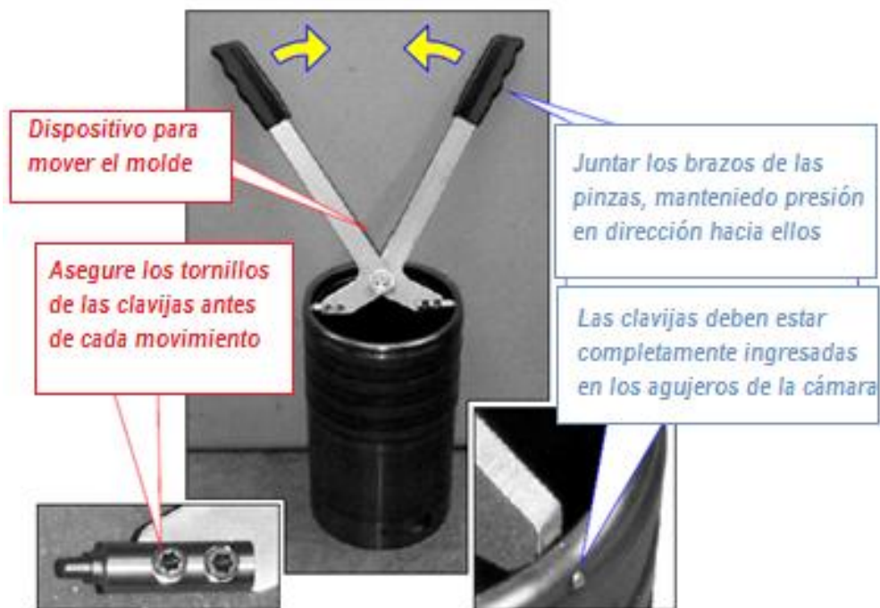
Gráfico 7-8: Pinzas con clavijas para desplazar el molde lleno de mezcla.
