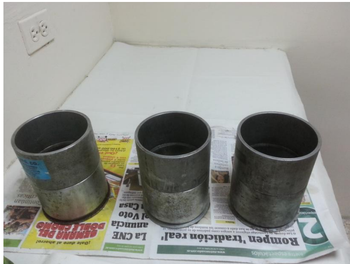
Gráfico 7-17: Moldes de compactación (4" de diámetro x 3" de altura) con sus respectivos collarines y bases.
