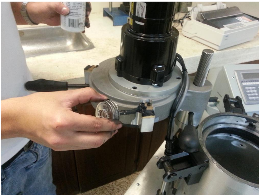
Gráfico 6-12: Lubricación de una sujeción de la abrazadera .
