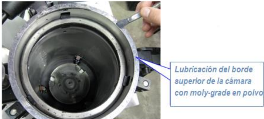
Gráfico 6-13: Polvo de disulfuro de molibdeno en borde superior de cámara.
