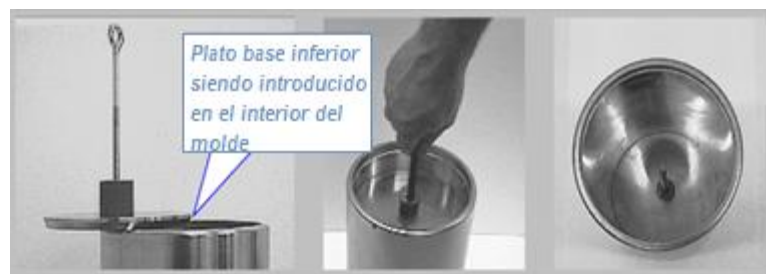
Gráfico 7-5: Plato base inferior introducido con el dispositivo magnético.
