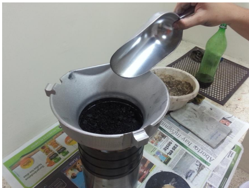
Gráfico 7-7: Embudo y cuchara para verter la mezcla en el molde.
