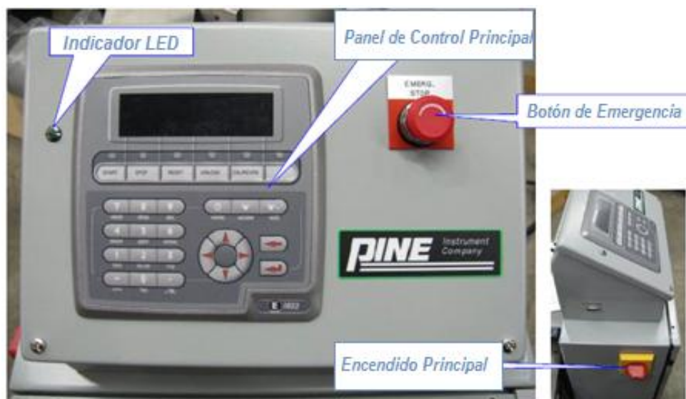
Gráfico 6-2: Controles principales del Compactador AFGB1.
