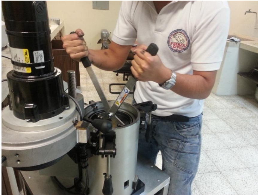
Gráfico 7-14: Extracción manual del molde con las pinzas de clavijas.
