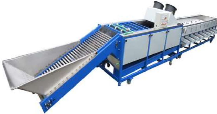
Figura 15. Máquina clasificadora para la fabricación de jugo de ciruela. Fuente: Shangai Genyond Machinery Industrial Group Limited (China)
