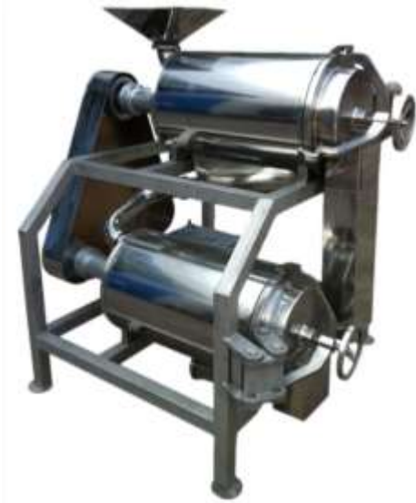
Figura 18. Despulpadora para la fabricación de jugo de ciruela. Fuente: Zhengzou Alpha Machinery Co., Ltd. (China)
