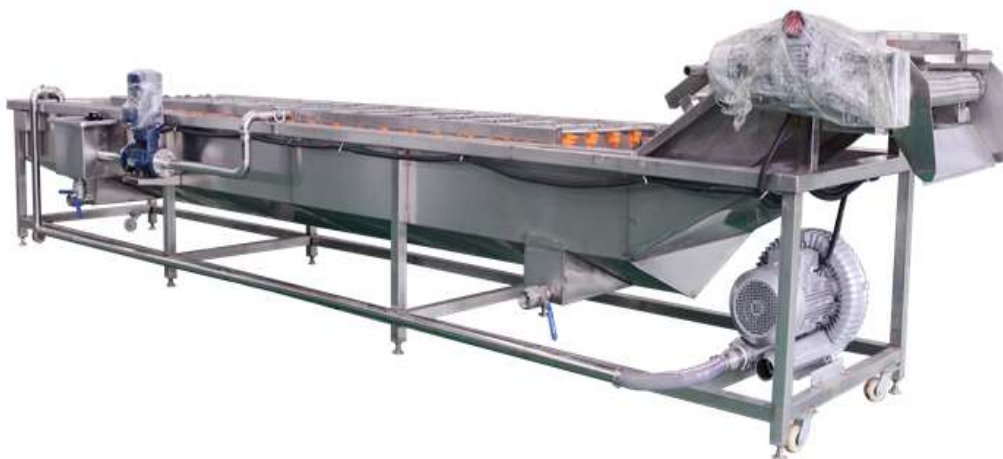
Figura 16. Máquina lavadora para la fabricación de jugo de ciruela. Fuente: Shangai Shanqiao Machinery Equipment Group Limited (China)
