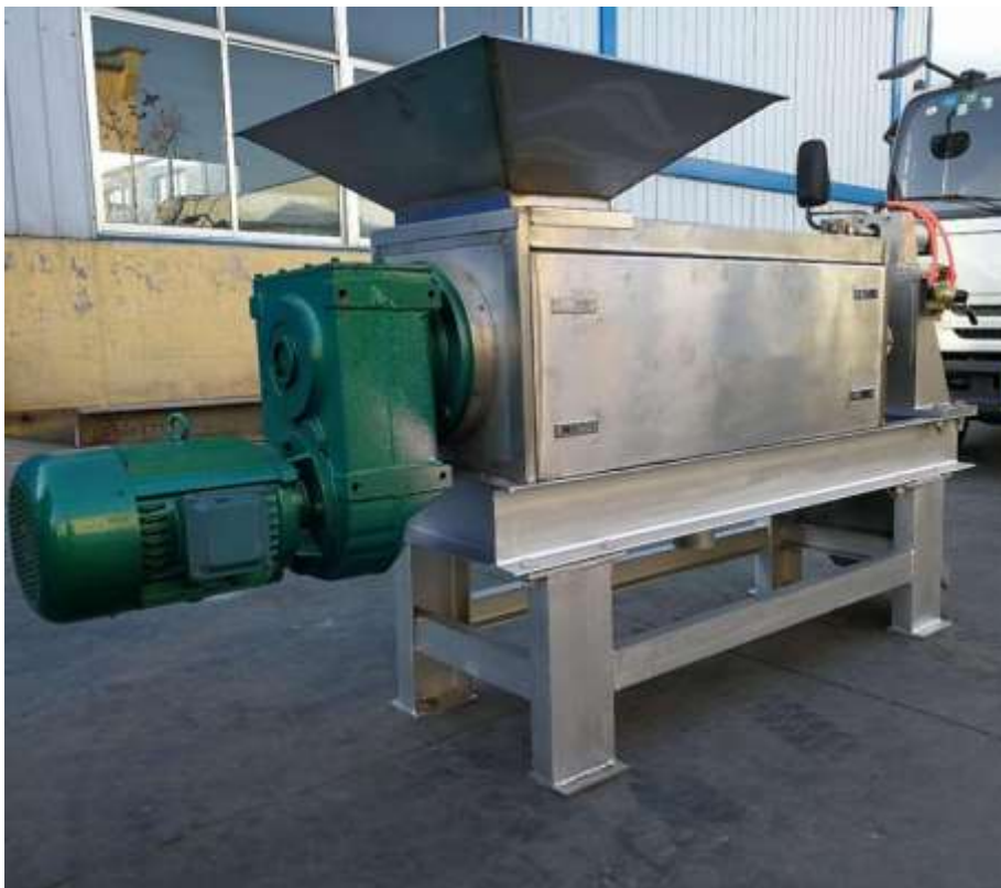
Figura 19. Prensa hidráulica para la fabricación de jugo de ciruela. Fuente: Xinxiang Dongzhen Machinery Co., Ltd. (China)
