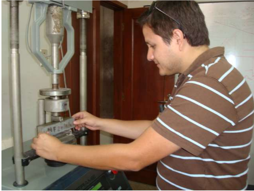
Foto 21. La carga se ejerce en el centro y perpendicular a la sección más corta de la probeta como se muestra en la foto
