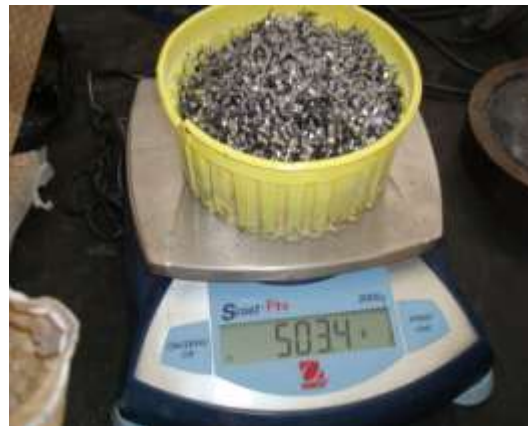
Foto 3. Balanza para calcular la dosificación de las fibras por saco de cemento, 1-3
