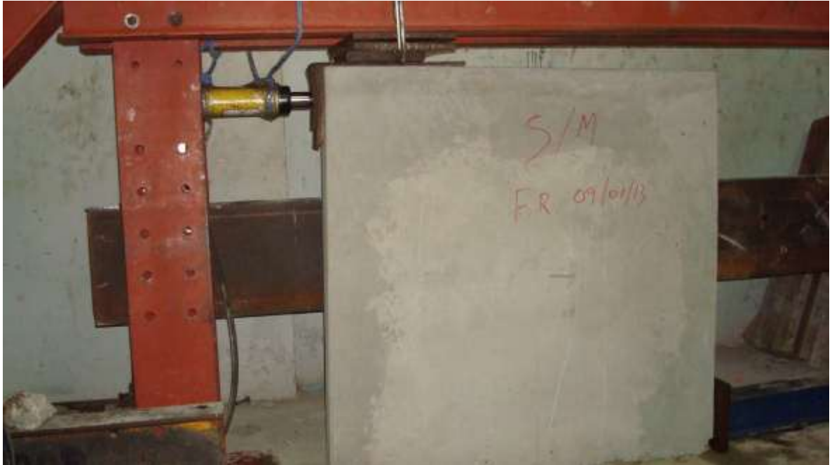
Foto 30. La pared preparada para ser sometida al ensayo
