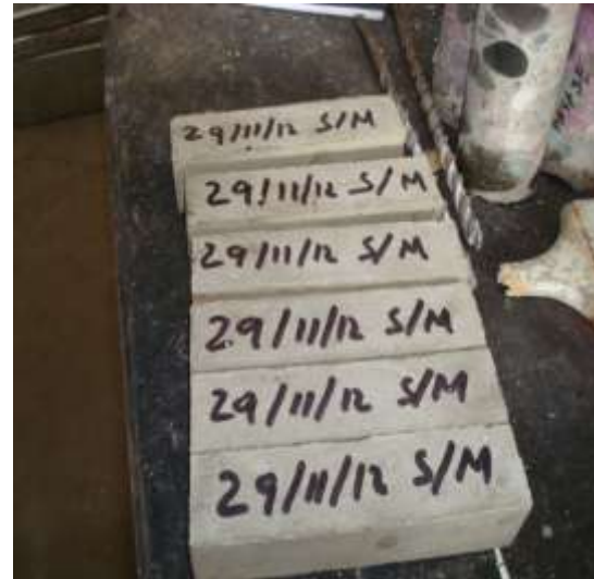
Foto 19. Desmolde de las muestras solo mortero
