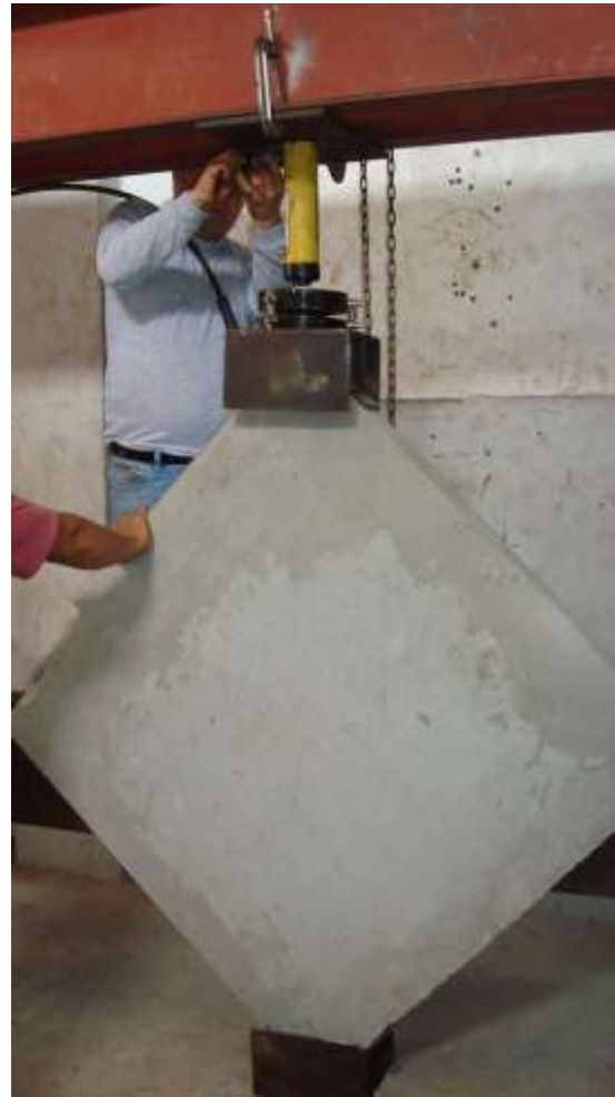
Foto 33. Graduación del gato hidráulico
