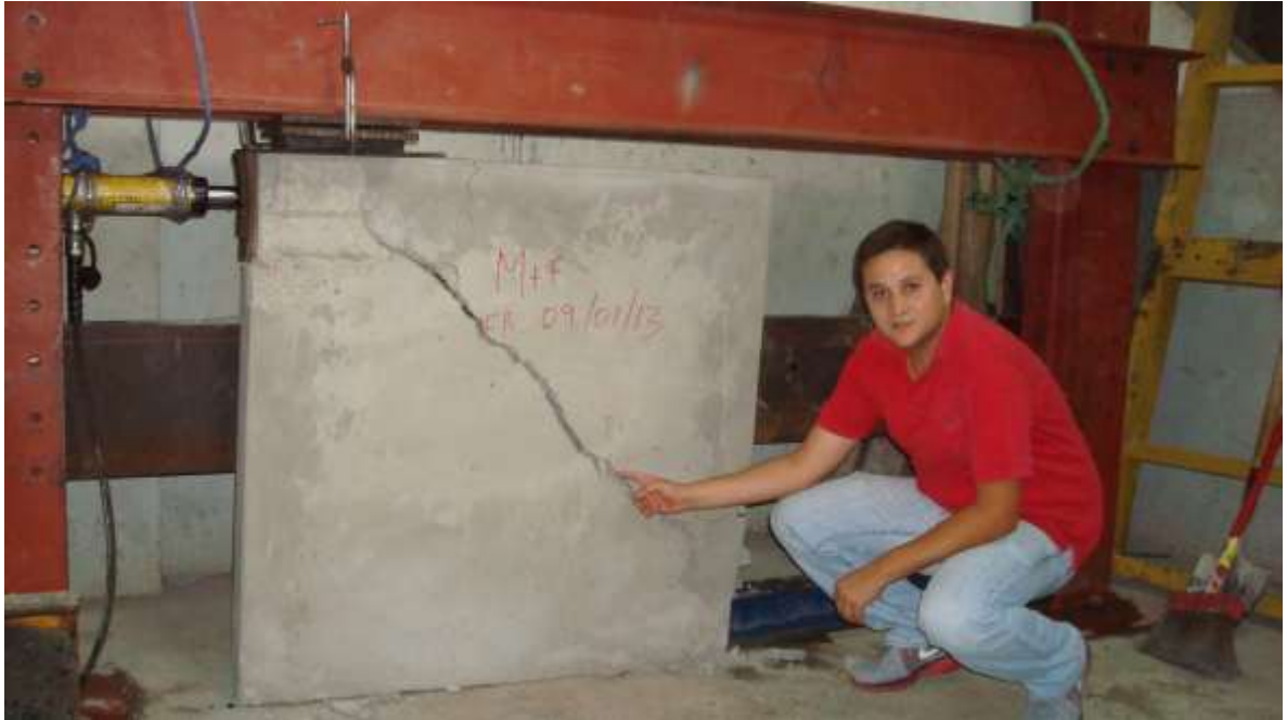
Foto 31. Falla de la pared de mortero + fibra a cortante
