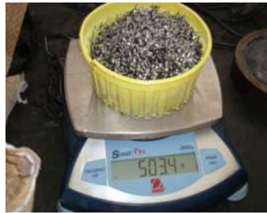
Foto 5. Balanza para calcular la dosificación de las fibras por saco de cemento, 3-3
