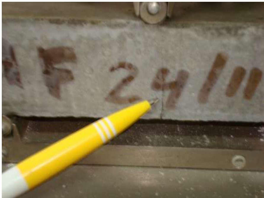
Foto 22. Falla de la probeta de mortero + fibra
