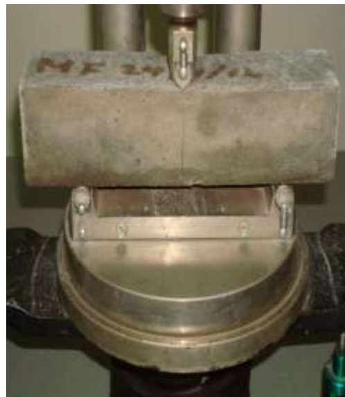
Foto 24. Falla de la probeta mortero + fibra, las fibras ayudan para que el elemento no se resquebraje
