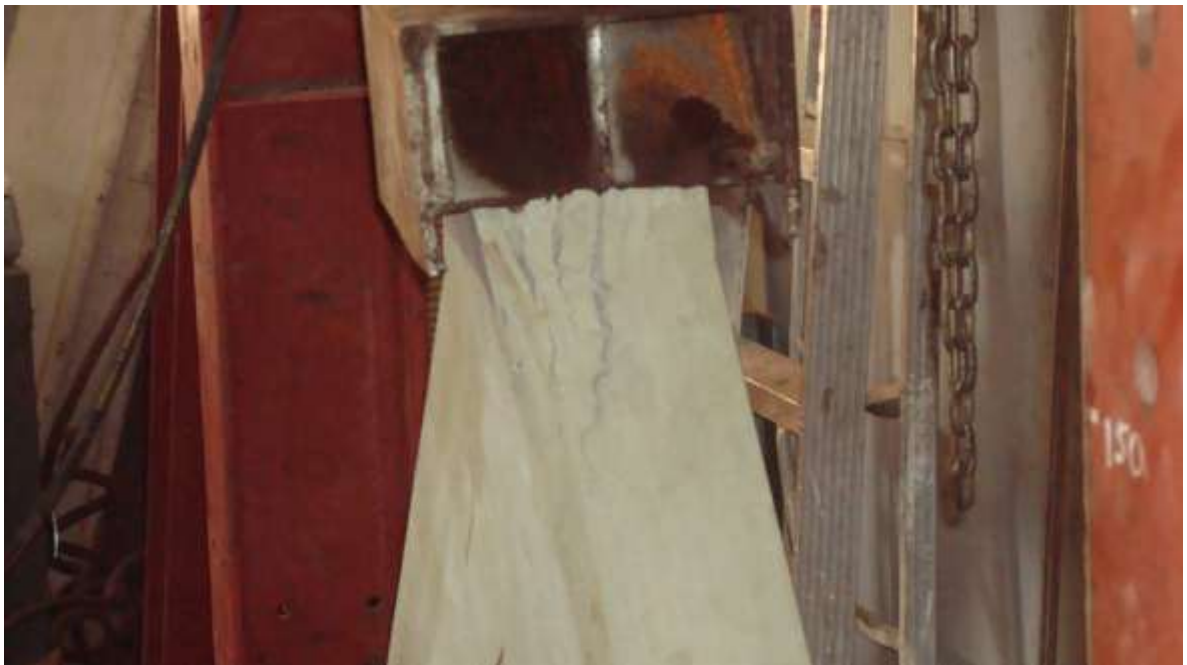
Foto 34. Falla en la punta superior, pared de mortero + fibra ensayo a compresión diagonal
