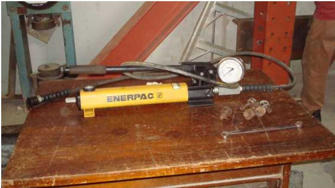
Foto 25. Gato Hidráulico ENERPAC RC 156 con capacidad de hasta 112 KN
