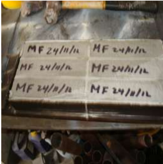
Foto 16. Desmolde de las muestras de mortero + fibra
