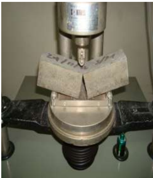
Foto 23. Falla de la probeta solo mortero
