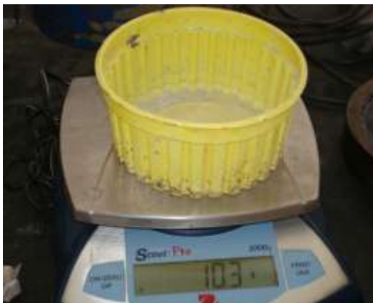
Foto 2. Balanza para calcular la dosificación de las fibras por saco de cemento, recipiente vacío
