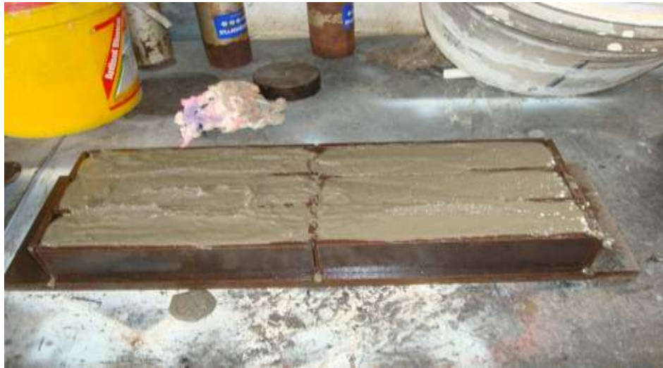
Foto 14. Colocación de la mezcla en los moldes
