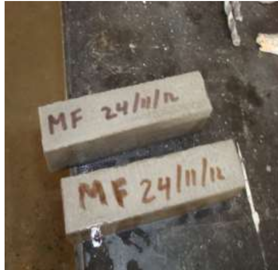
Foto 17. Desmolde de las muestras mortero + fibra
