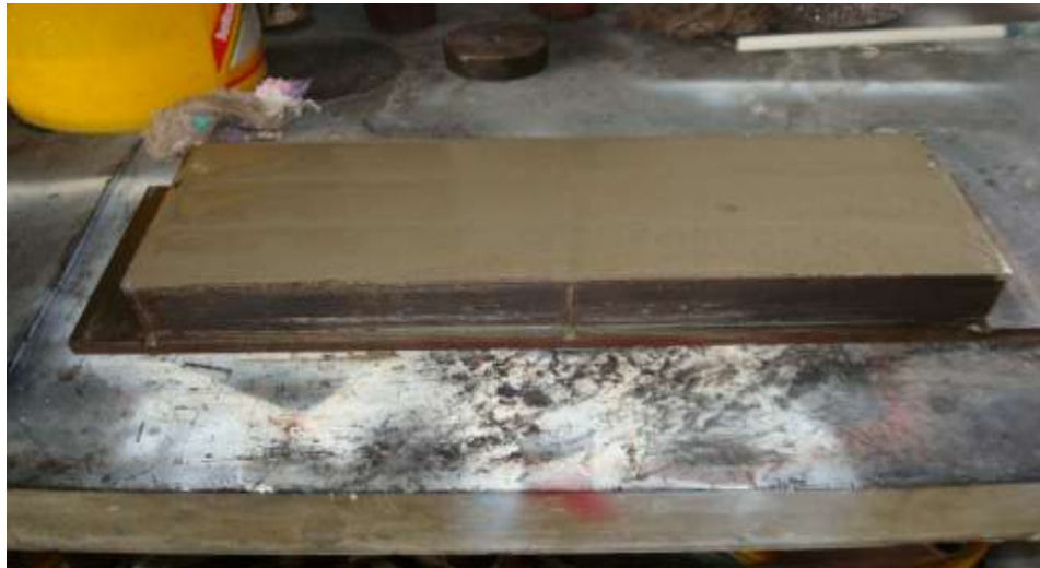
Foto 15. Las muestras listas para ser desmoldadas una vez transcurridas las 24 horas
