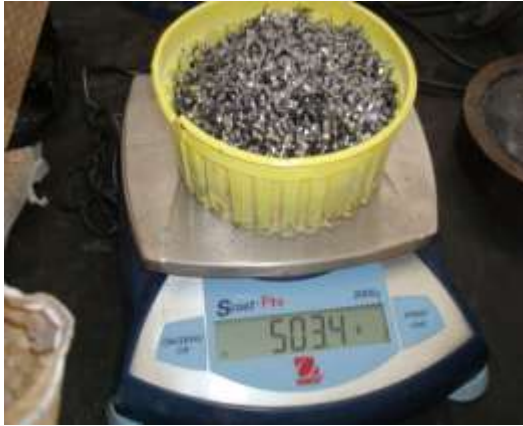
Foto 4. Balanza para calcular la dosificación de las fibras por saco de cemento, 2-3
