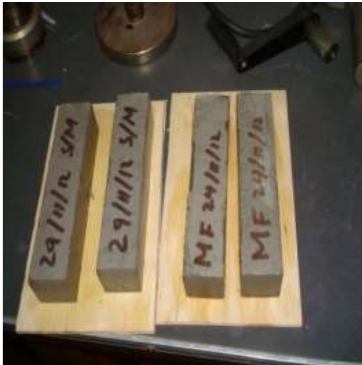
Foto 18. Desmolde de las muestras con y sin fibra
