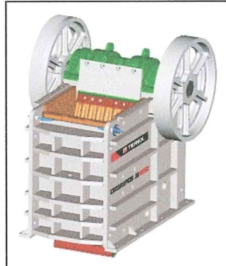
GRÁFICO # 1 TRITURADORA DE MANDÍBULAS
