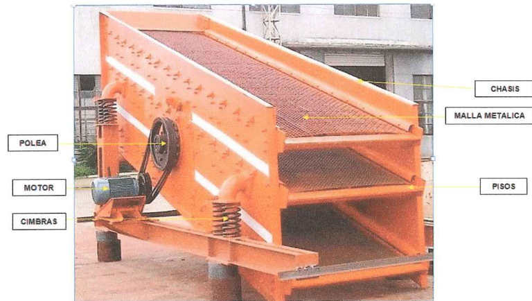
GRÁFICO # 12 PARTES DE CRIBADORA
