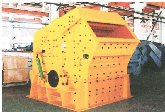
GRÁFICO # 6 TRITURADORA DE IMPACTO HORIZONTAL
