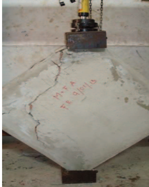
GRÁFICO 31. ENSAYO DE PARED DE MORTERO MÁS FIBRA
