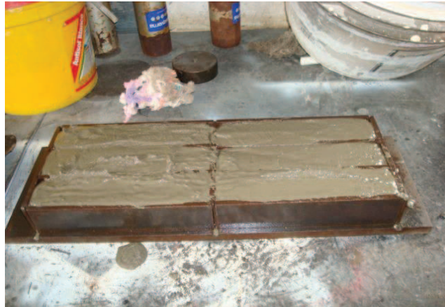
GRÁFICO 15. COLOCACIÓN DE LA MEZCLA EN LOS MOLDES
