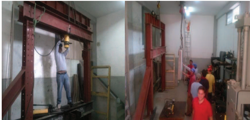
GRÁFICO 28. COLOCACIÓN DE LA PARED DENTRO DEL PÓRTICO
