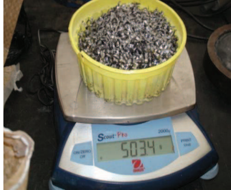
GRÁFICO 11. PESO DEL RECIPIENTE MÁS LAS FIBRAS DE ACERO
