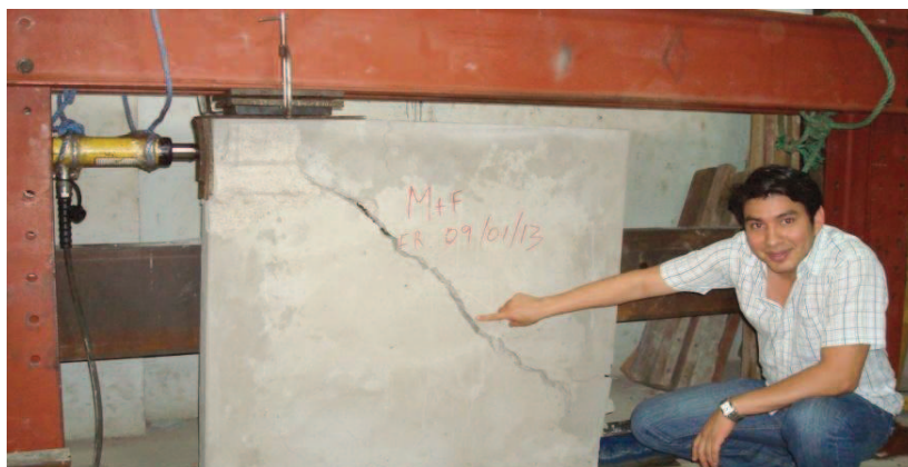
GRÁFICO 33. FALLA PRODUCIDA POR CORTANTE
