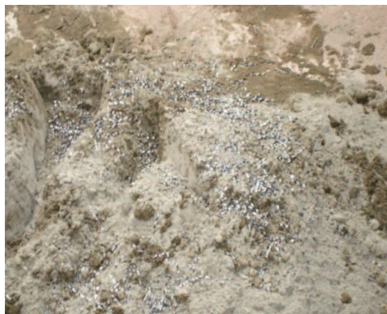
GRÁFICO 12. FIBRAS DE ACERO ESPARCIDAS EN LA MEZCLA
