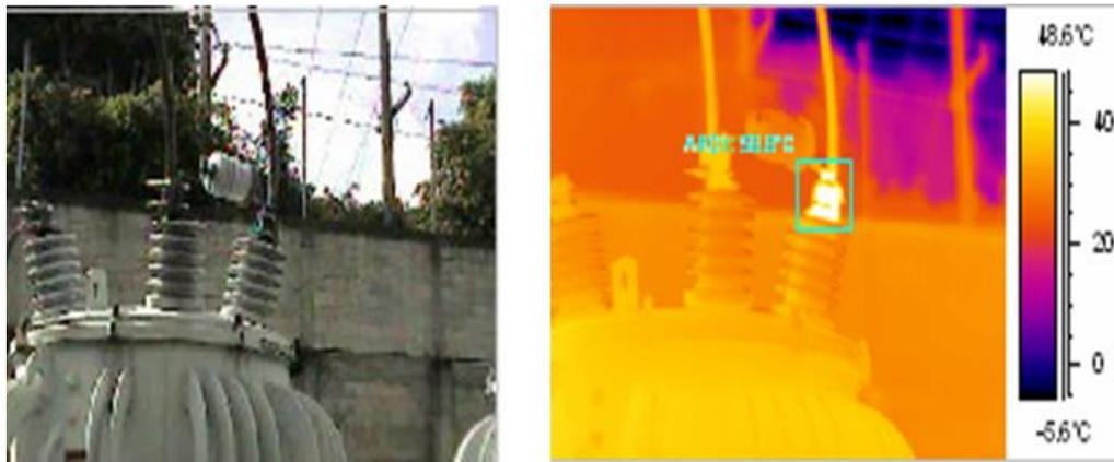
Figura 3. 8 Termografía infrarroja de un regulador de voltaje.
