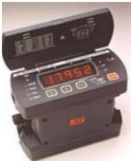
Ducter para medición de baja resistencia
