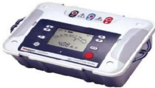
Medidor de resistencia de aislamiento
