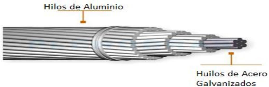
*Figura 2. 14. Conductor de aluminio 336*
