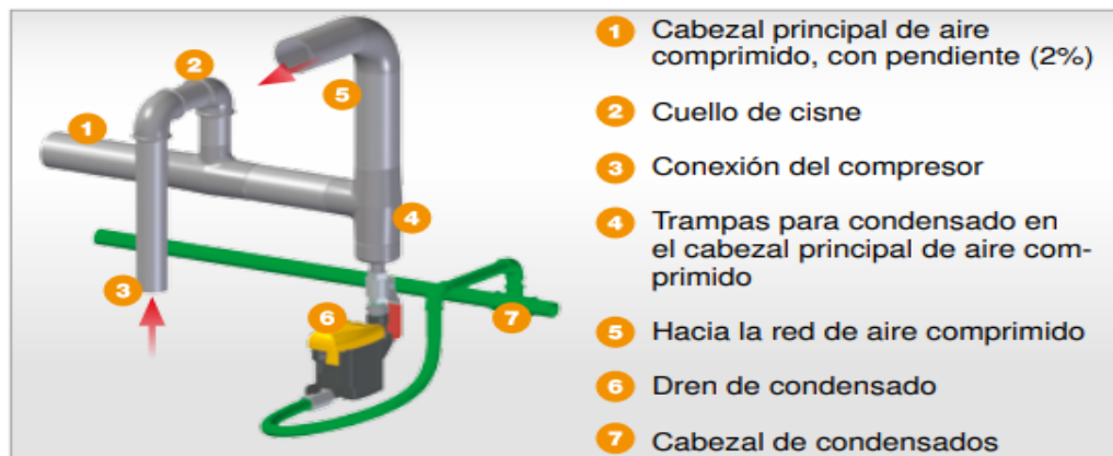
Figura 2. 15 La trampa y sus partes
