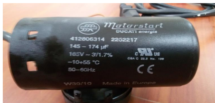
Figura N° 2.- Capacitor con los datos de placa
