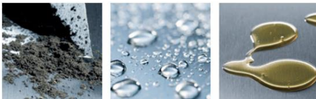
Figura 2. 2 Tres elementos perjudiciales del aire comprimido
