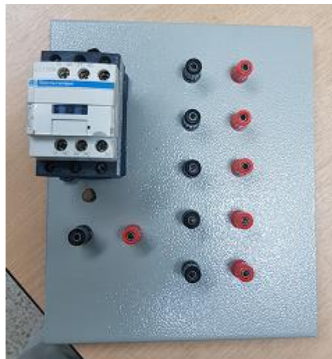
Figura 3. 16: Lamina de contactores terminada. Fuente: Autor
