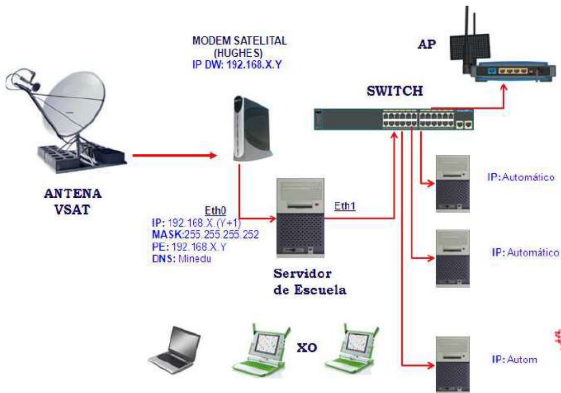
Figura 3. 18 Configuración de equipos con switch de comunicación. Fuente: (PERUEDUCA, 2013)
