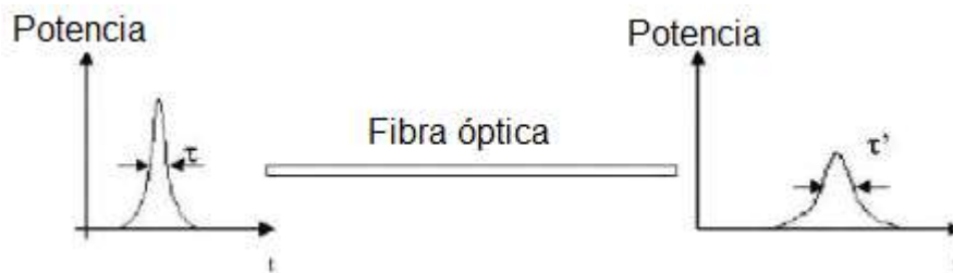
Figura 2. 10: Dispersión cromática en una fibra óptica. Fuente: (Palacios Meléndez, 2017)
