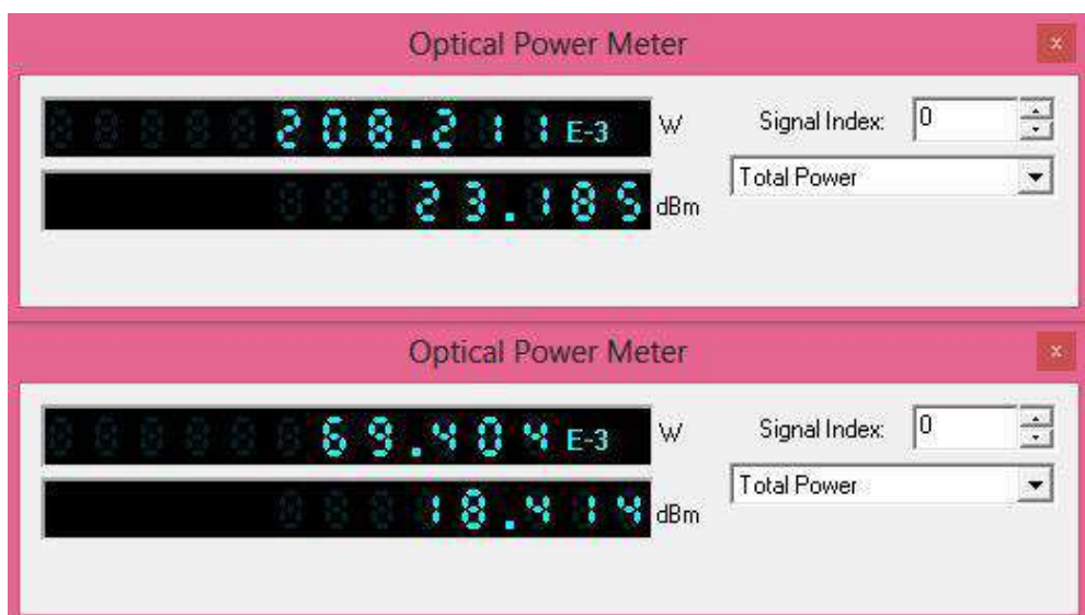
Figura 3. 8: Comparaciones de potencia antes y después de divisor de potencia. Elaborado por: Autor.
