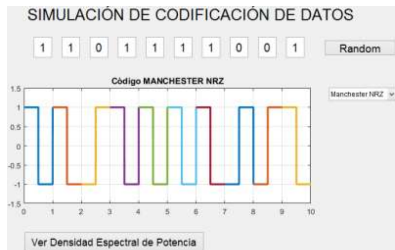
Figura 3. 14: Generación de bits del código Manchester NRZ. Elaborado por el Autor.
