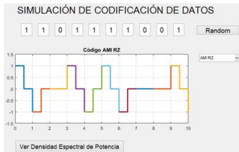
Figura 3. 13: Generación de bits del código AMI RZ. Elaborado por el Autor.
