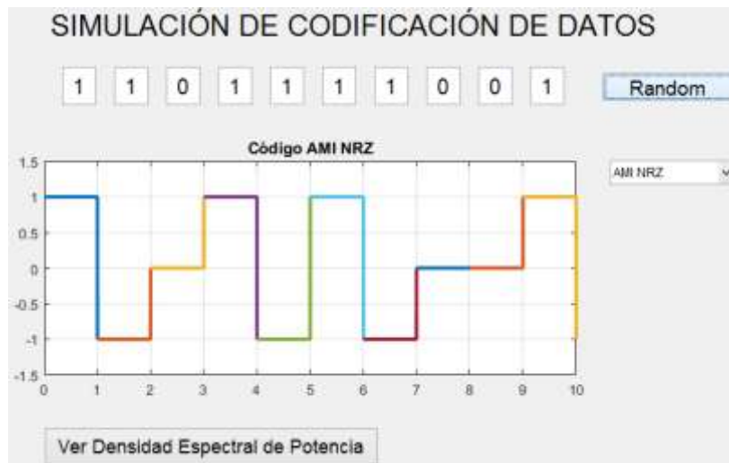
Figura 3. 12: Generación de bits del código AMI NRZ. Elaborado por el Autor.
