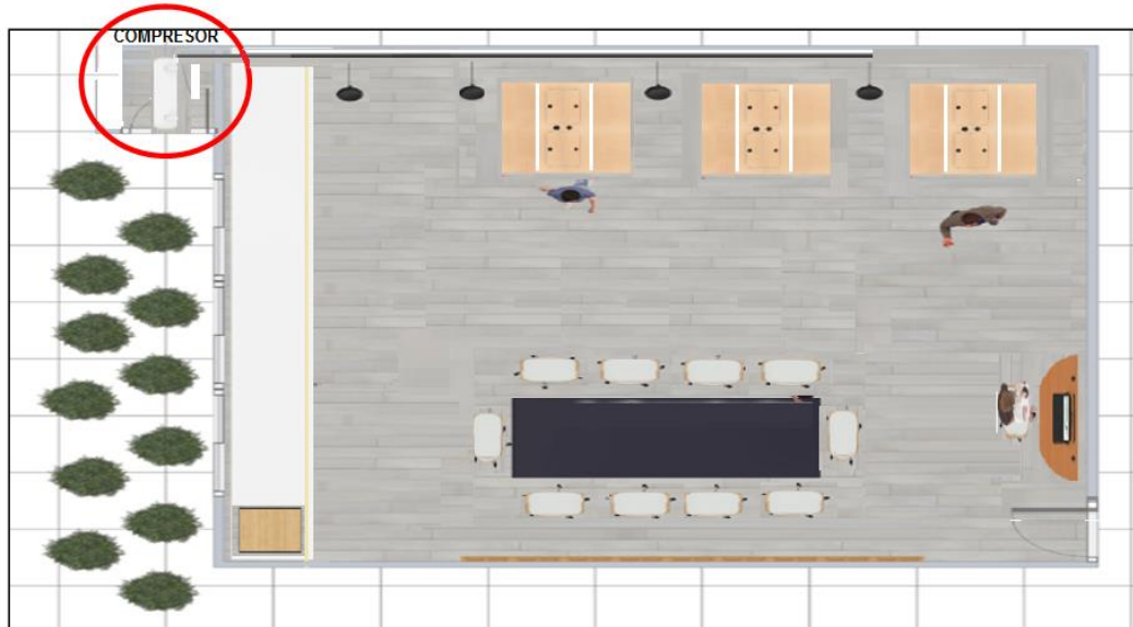
Figura 4. 5 Cuarto de compresor en exteriores del laboratorio de Neumática
