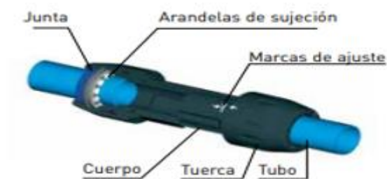
Figura 4. 8 Acople para tubos (roscados y con arandela) de diámetros 25mm
