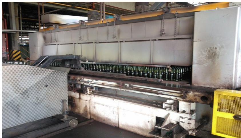
Figuras 2.1 Acondicionador de envases de vidrio Fuente: Autor
