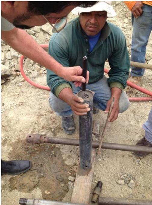
***Figura 8: Prueba con penetrómetro en el extremo de un tubo Shelby después de la extracción de la muestra.***
