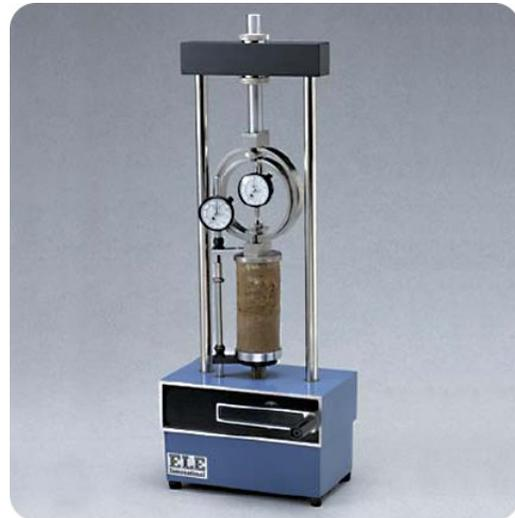
**Figura 11: Moldeo del espécimen y equipo utilizado para la prueba de compresión simple.**
