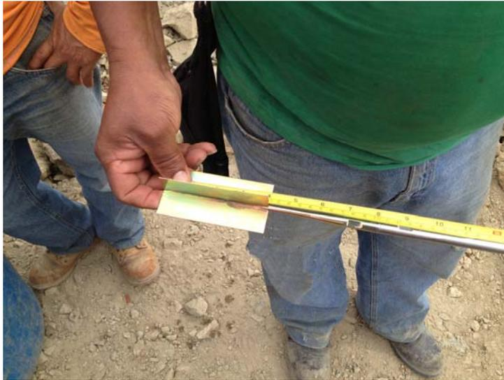
**Figura 5: Medición de las aspas de la veleta utilizada en la prueba.**
