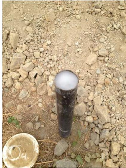
**Figura 3: Tubo Shelby sellado con parafina después de su extracción.**
