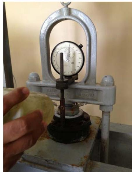
**Figura 12: Equipo utilizado para el ensayo de consolidación y deformímetro en el que se hacen las lecturas de cambios de altura.**
