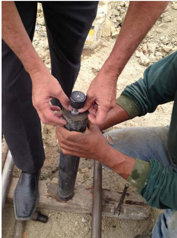
**Figura 7: Prueba con torvane en el extremo de un tubo Shelby después de la extracción de la muestra.**
