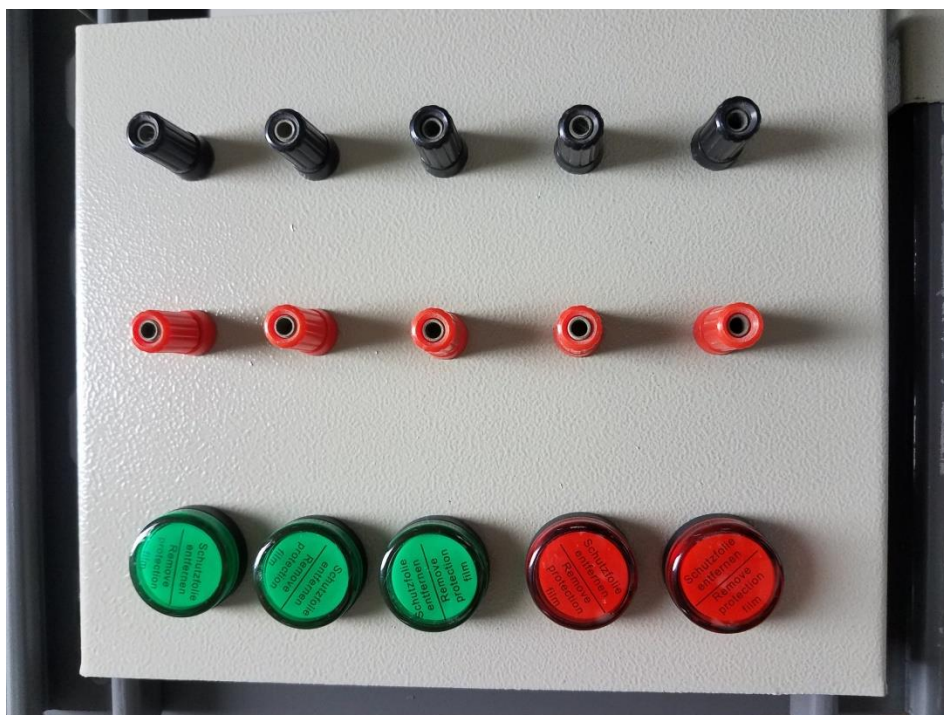
Figura 45. Placa de luces piloto.
