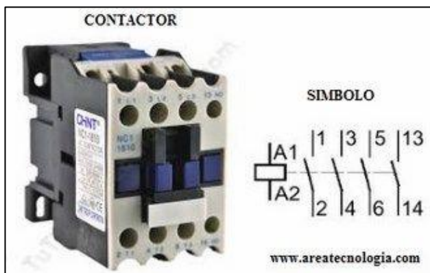
Figura 1: Contactor y sus símbolos en circuitos.
