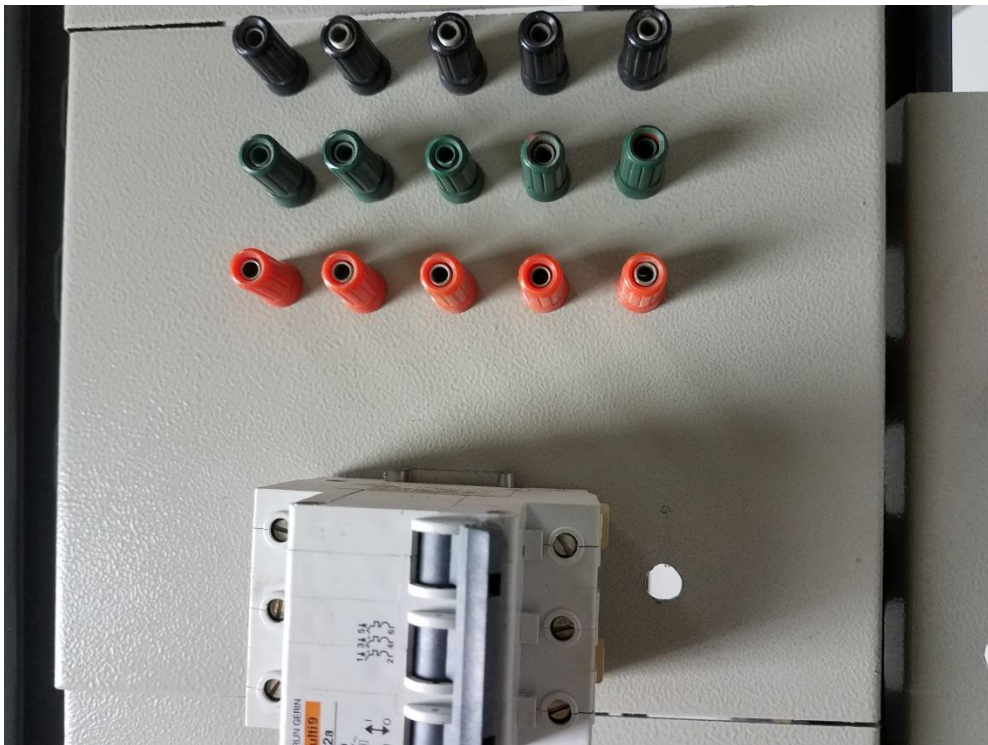
Figura 47. Placa de breaker trifásico.
