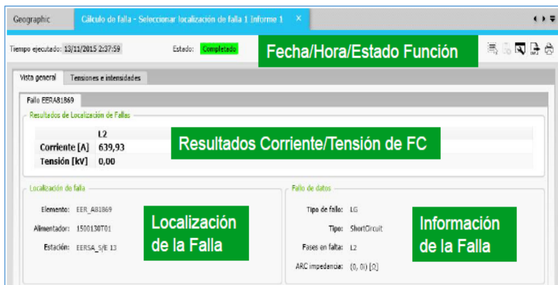
Figura 8.9: Localización de falla. Fuente: Sistema DMD
