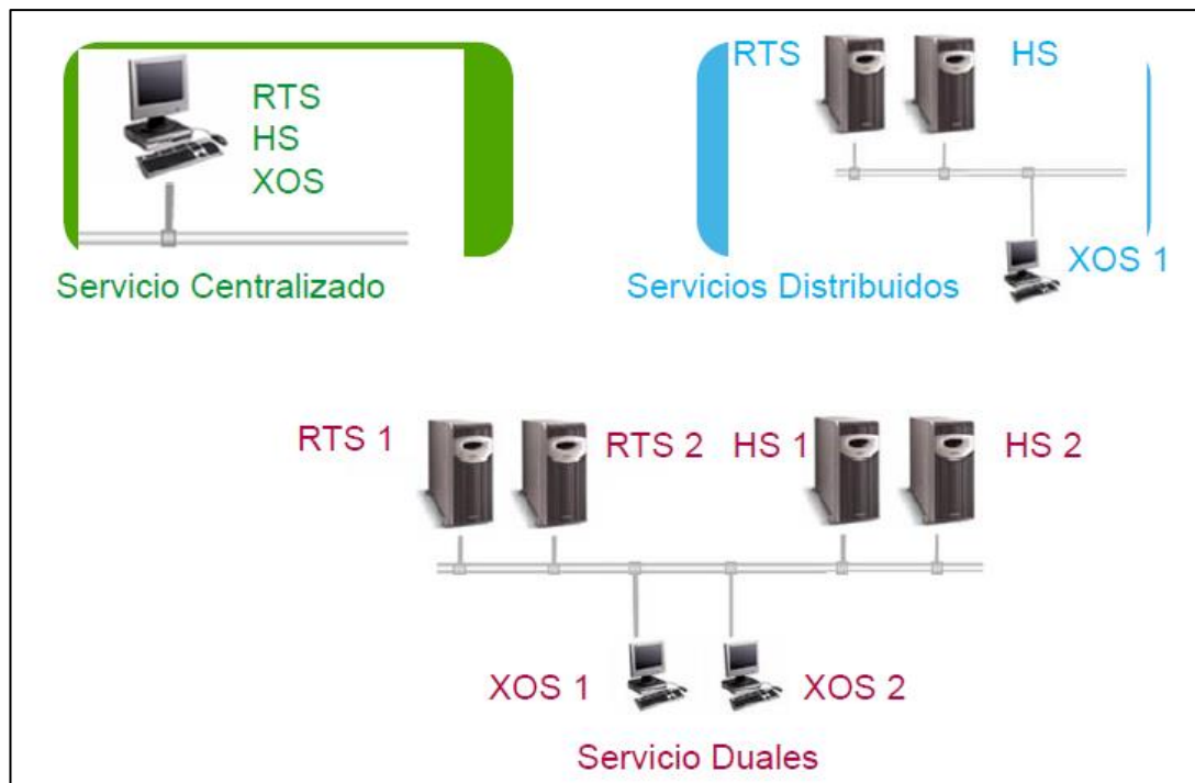
Figura 3.2: Topologías OASYS DNA Fuente: (Telvent, 2016)
