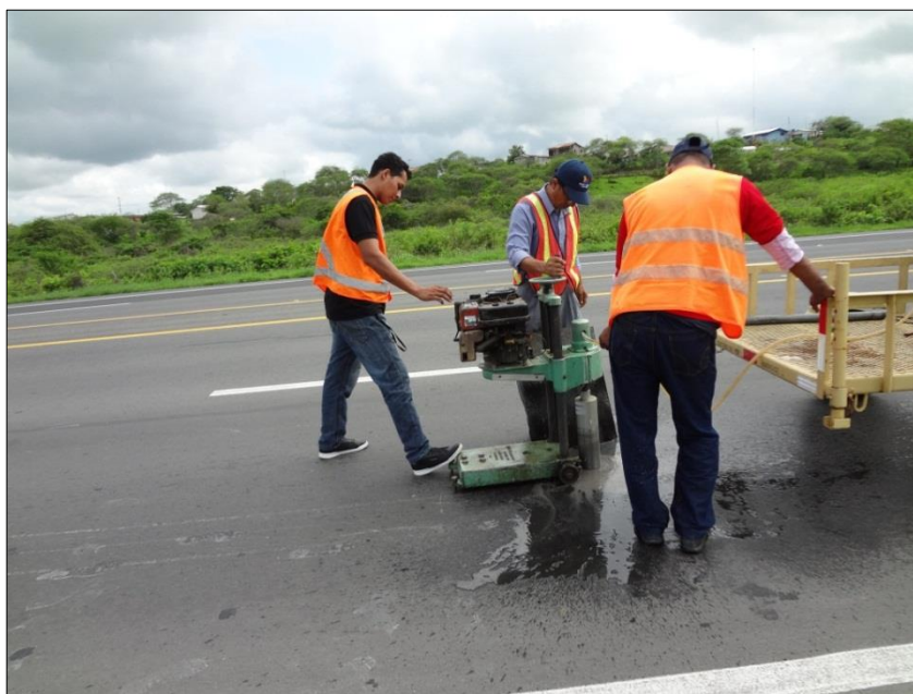
Figura 3-1: Extracción de núcleos en Vía Progreso – Playas
