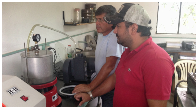
FOTO 11. ENSAYOS CON BRIQUETAS CON SATURACIÓN DE AGUA DEL 60% AL 80%
