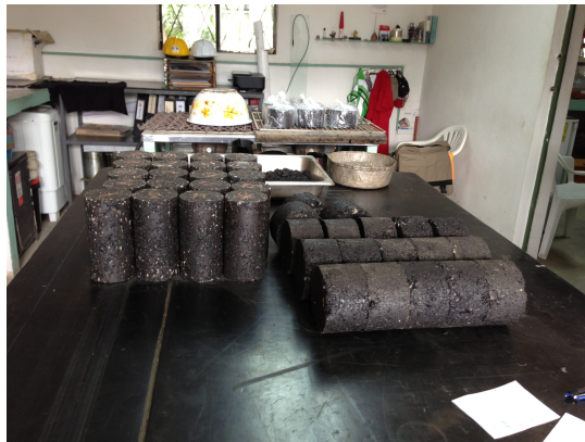
FOTO 10. BRIQUETAS Y CILINDROS ELABORADOS PARA LOS ENSAYOS
