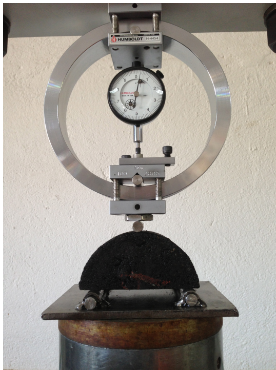
FOTO 7. ENSAYO DE FLEXIÓN SEMICIRCULAR
