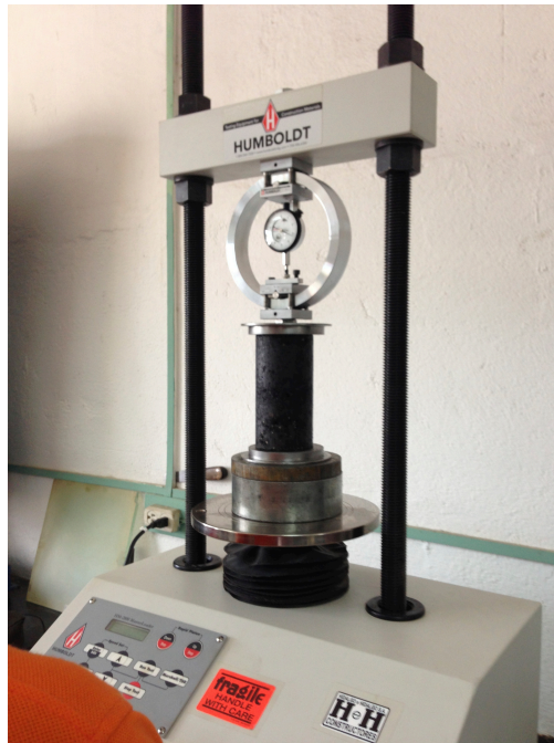
FOTO 5. ENSAYO DE COMPRESIÓN SIN CONFINAMIENTO LATERAL
