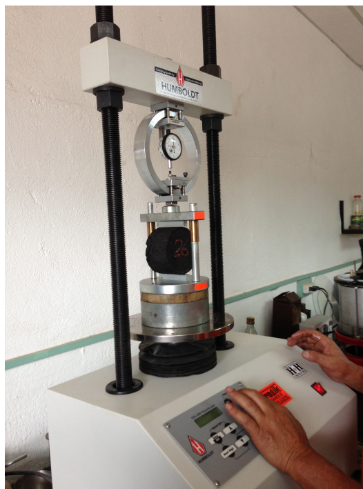
FOTO 6. ENSAYO DE TRACCIÓN INDIRECTA
