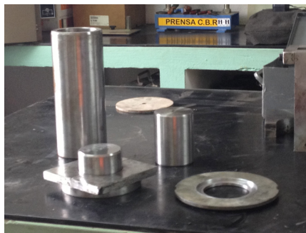
FOTO 2. MOLDES PARA ELABORACIÓN DE CILINDROS Y CILINDRO
