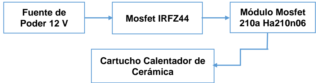
Figura 3. 3: Diagrama 3, Conexiones de Hardware
