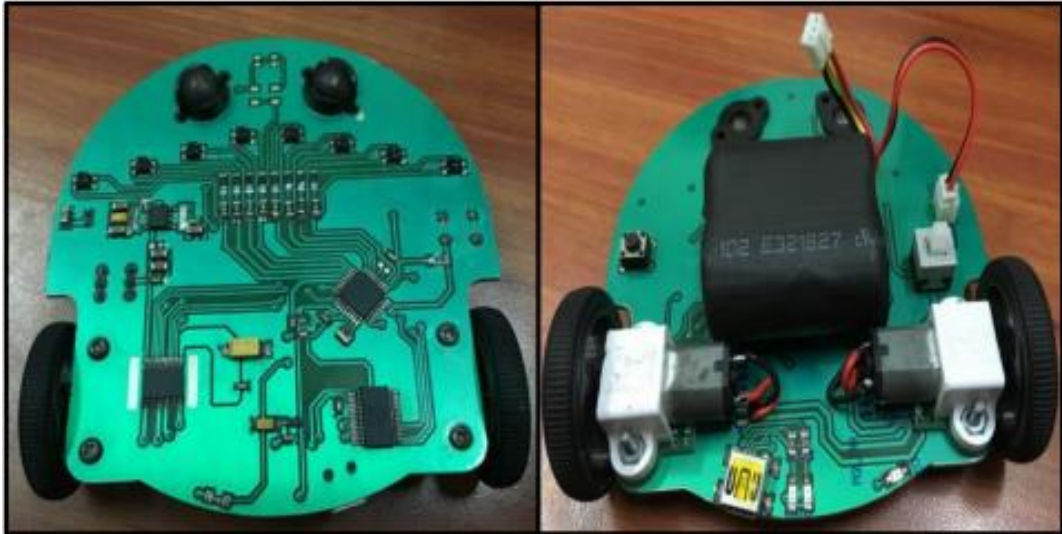
Figura 3. 16: Vista inferior y superior del robot seguidor de línea utilizado para el desarrollo del controlador PID.
