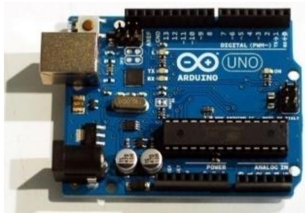
Figura 3. 2: Tarjeta ARDUINO UNO incorporado el microcontrolador ATmega328P. Fuente: (Sam, Mohd Nor Md Tan, & Mohamad Safari Ismail, 2013; Sudhan et al., 2015).
