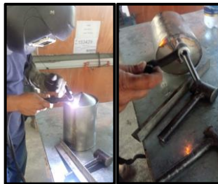
Figura 3. 8. Fijación de tapas cónicas para tanques Elaborado por: Autor
