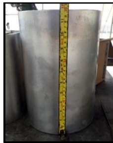
Figura 3. 4. Plancha enrolada de 30cm. x 20diam Elaborado por: Autor
