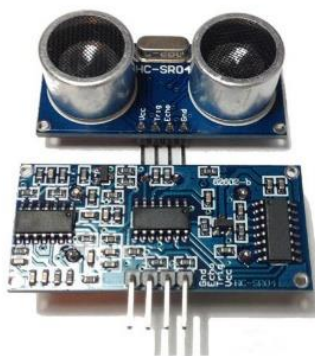
Figura 2. 42. Sensor Ultrasónico (Pena & Pardal, 2015, p. 39).
