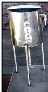
Figura 3. 14. Instalación de visor al tanque de proceso Elaborado por: Autor
