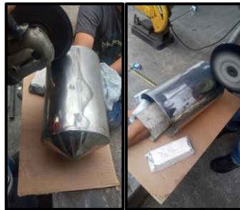
Figura 3. 13. Proceso de pulida de tanques Elaborado por: Autor
