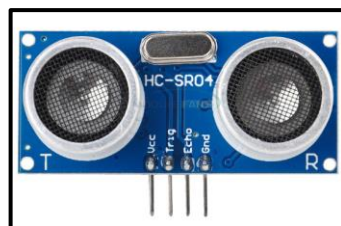
Figura 3. 19. Sensor ultrasónico Fuente: (Osakaelectronicstda).
