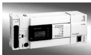
Figura 2. 29. Mitsubishi compact PLC Fuente: (Bolton, 2006, p. 11).
