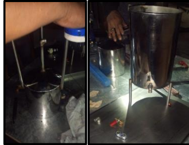
Figura 3. 10. Instalación de los tanques a la base metálica Elaborado por: Autor
