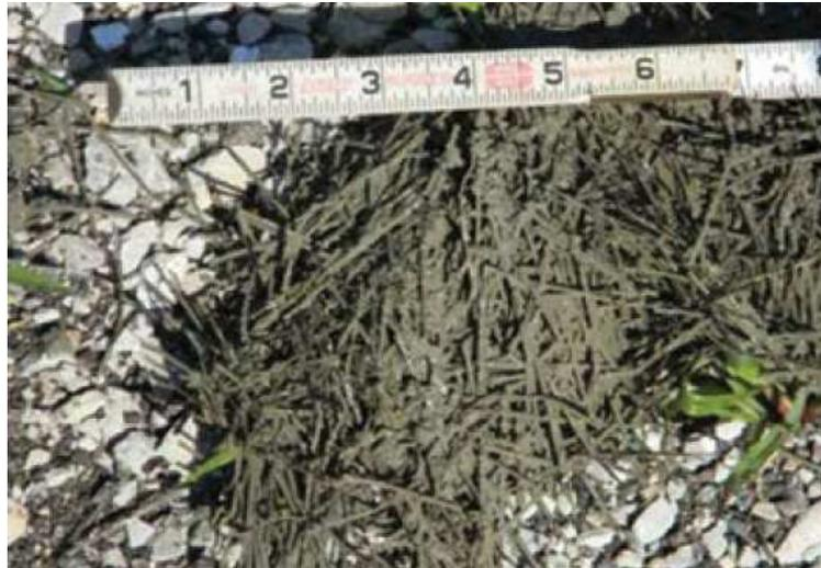
**Figura 2.12.- Empleo de fibras sintéticas en losas de concreto**
