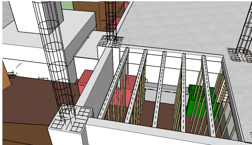
Ilustración 174.- Fundición de muro perimetral Fuente: Autor
