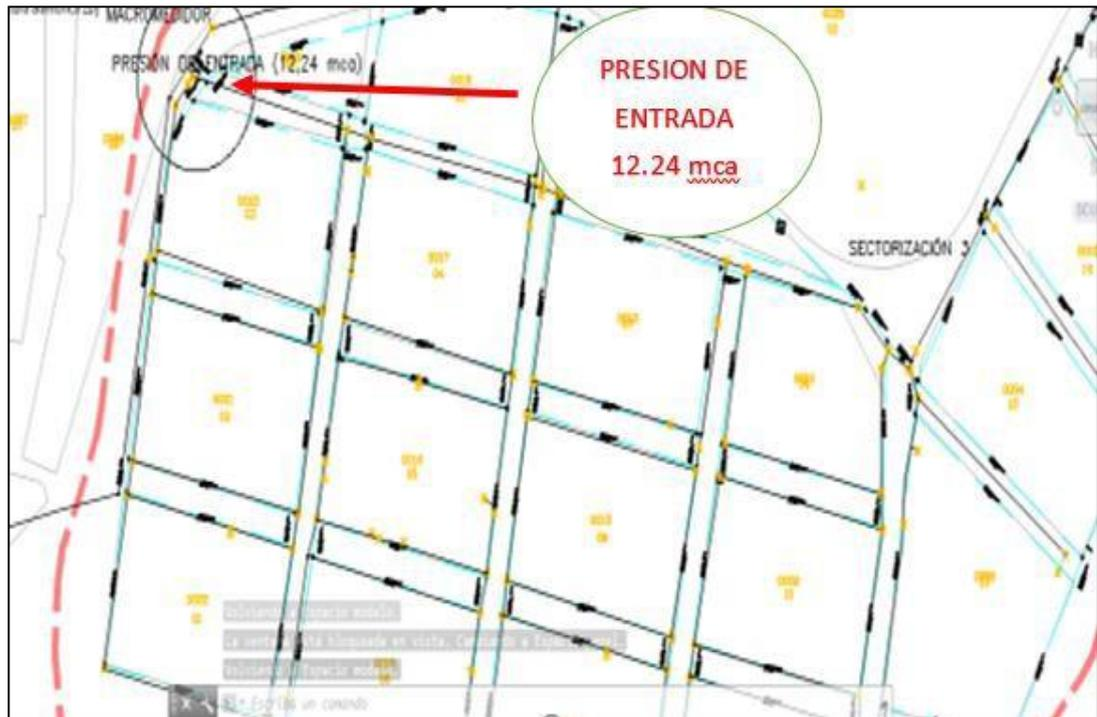
Ilustración 7 Punto de conexión y Presión de entrada
