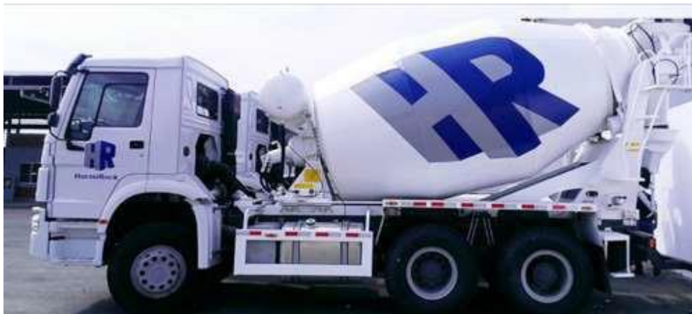
Ilustración 6: Mixers que Transportan el Hormigón
