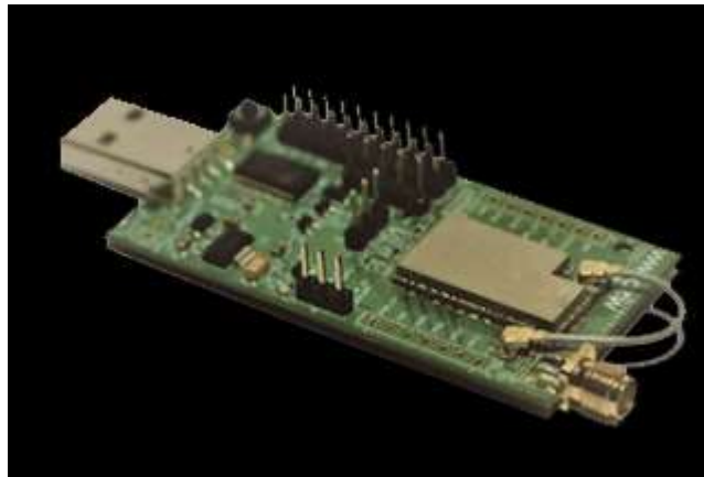
Figura 9. RCZ2 SIGFOX Module. Nota: tomado de M2Communication Inc. (2018)
