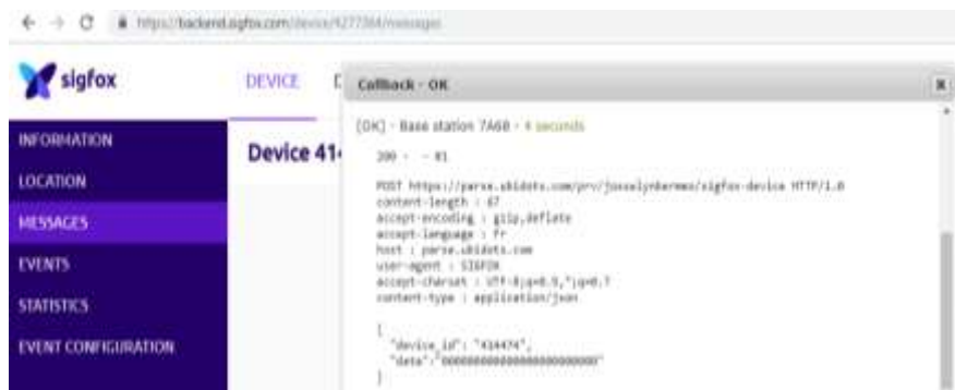
Figura 48 Envío de información del servidor sigfox al servidor Ubidots a través del CALLBACK
