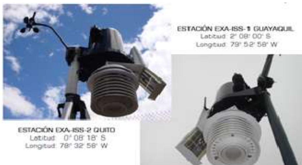
Figura 32. Estaciones robóticas de EXA en Guayaquil y Quito. Fuente: Agencia Espacial Ecuatoriana (EXA)
