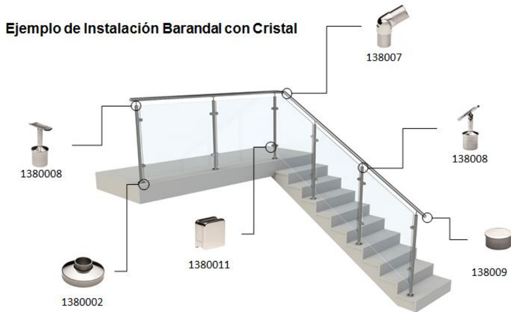
Figura 8. Instalación en escalera
