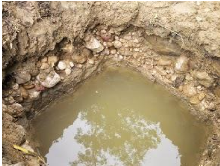
Imagen 10: Abscisa 4+100. Visualización de los estratos del pozo 1.
