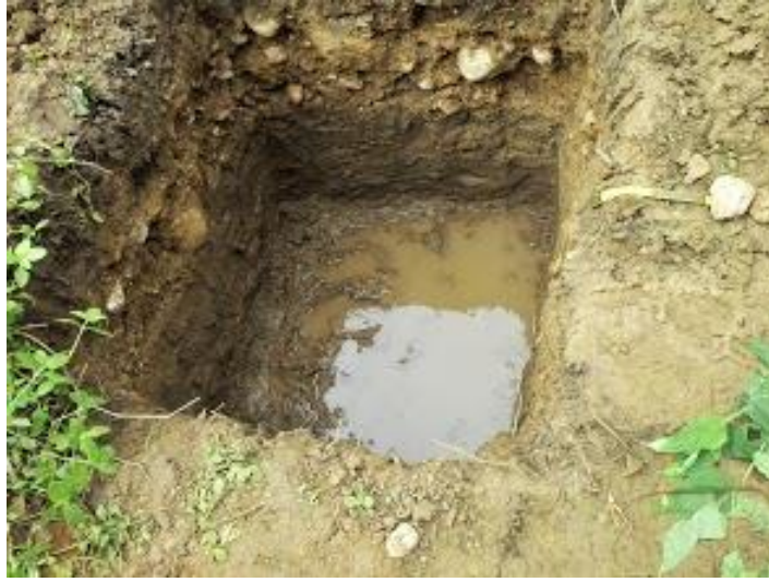
Imagen 11: Abscisa 0+000. Aparición del gasto constante en el estrato permeable.
