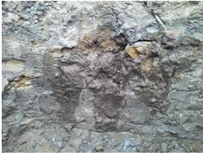
Imagen 3: Abscisa 0+000. Aparición del gasto variable en el estrato permeable.
