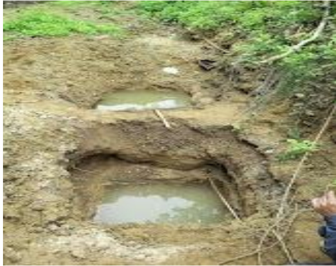
Imagen 15: Abscisa 9+600. Mediciones en campo de la prueba con gasto constante.
