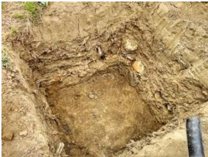
Imagen 6: Abcisa 1+000. Visualización de los estratos del pozo 1.
