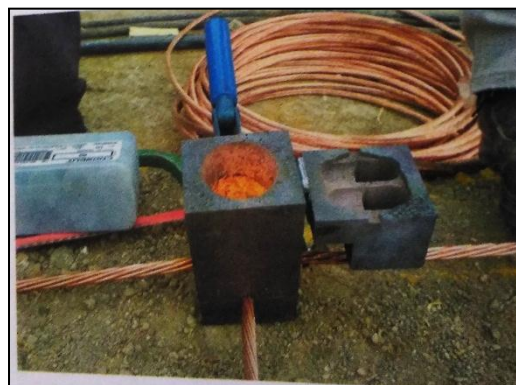
Figura: 2.31: Soldadura exotérmica Fuente: ( Trashorras Montecelos, 2015 )
