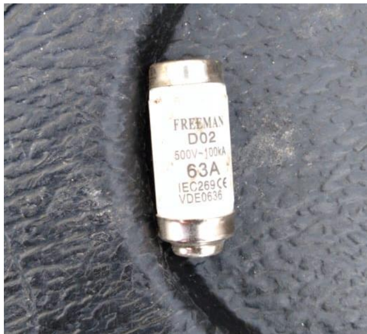
Figura 2.18: Fusible de 63 Amp.
