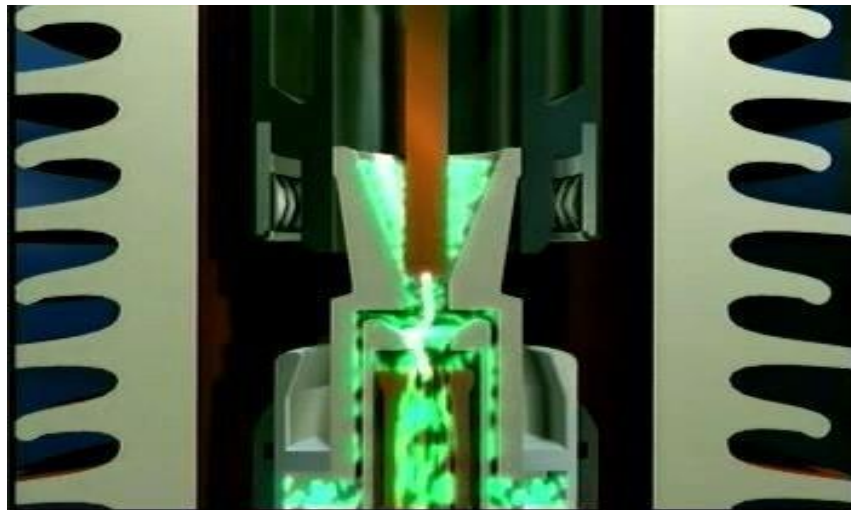
Figura 3 Interruptor de auto soplado en SF6
