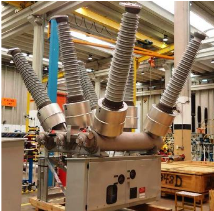
Figura 11. Interruptor de Tanque Muerto DT1-72.5
