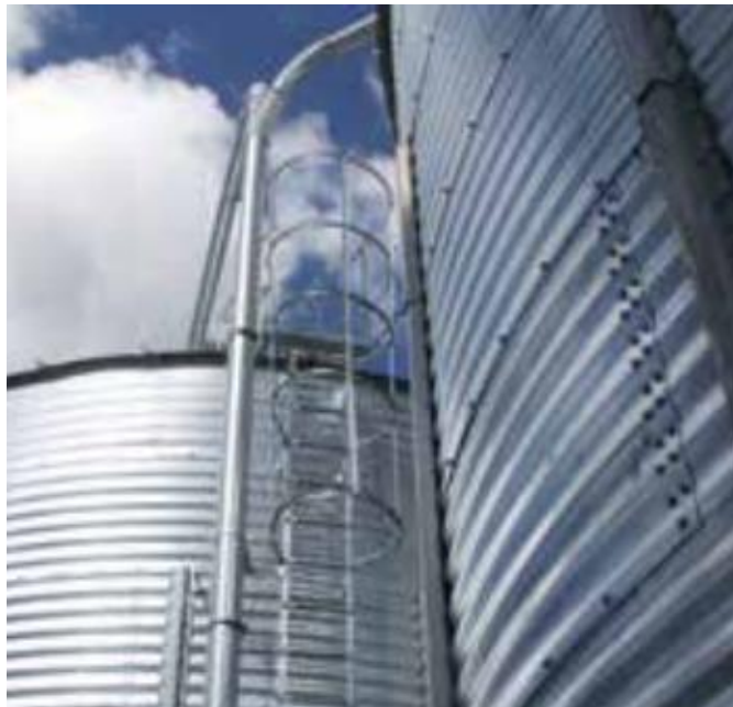
Figura 2.19: Montaje de tuberías para el llenado de silos de exterior Fuente:(Kongsilde, 2017)
