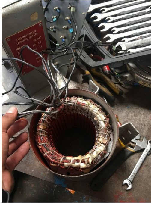
Figura 32: Las líneas de fase Tomada de: Autor
