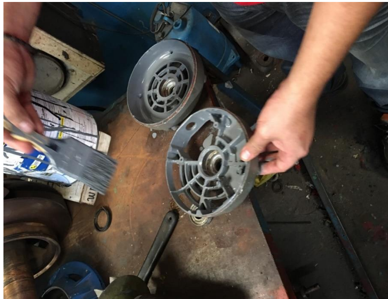
Figura 34: Pintada de la carcasa del motor Tomada de: Autor
