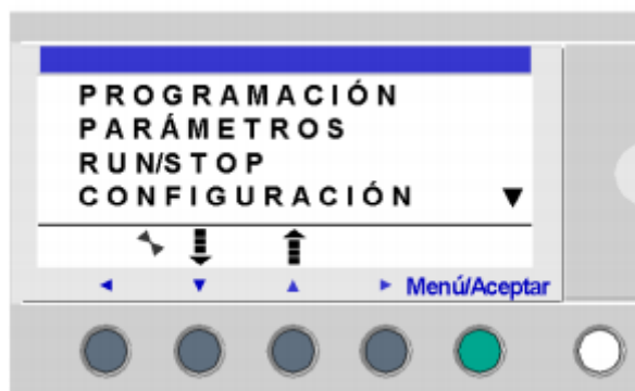
Figura 43: Teclas de comando Tomado de: (Schneider Electric, 2017)
