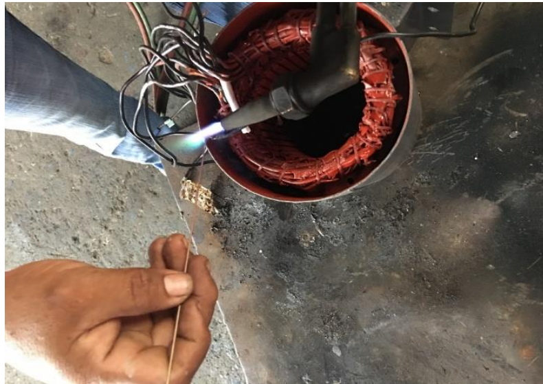
Figura 35: Soldando la línea Tomada de: Autor
