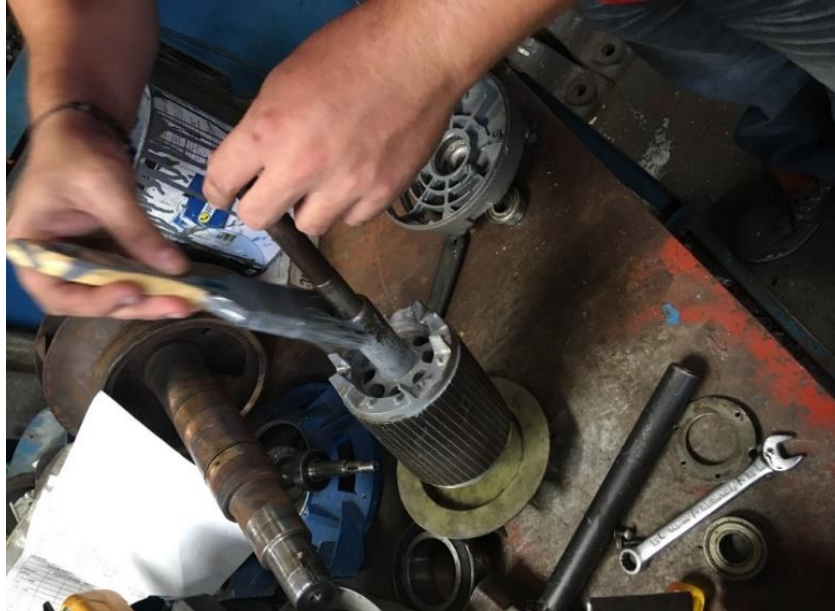
Figura 33: Limpieza y pintada del rotor Tomada de: Autor
