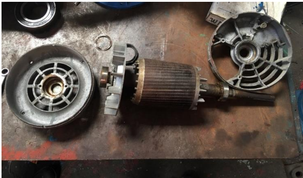
Figura 30: Rotor, ventilador, eje y rodamientos Tomado de: Autor
