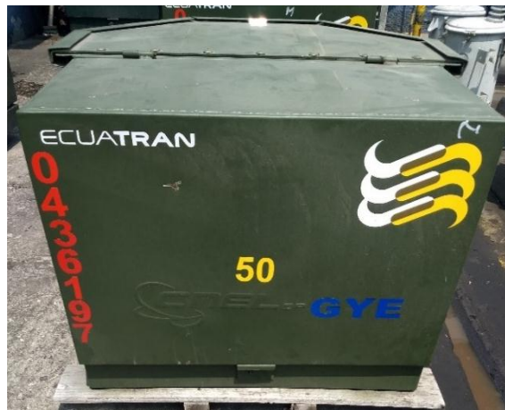
Figura 2. 30. Transformador pad mounted monofásico
