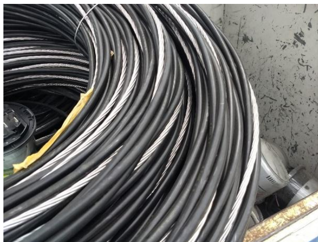
Figura 2. 40. Acometida baja tensión para residencia
