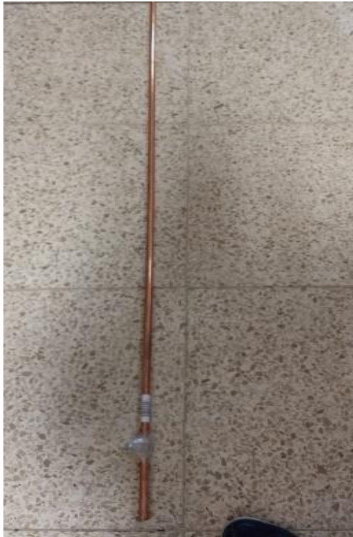
Figura 2. 25. Varilla puesta a tierra
