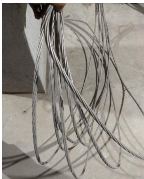
Figura 2. 22. Cable ASC - AAC
