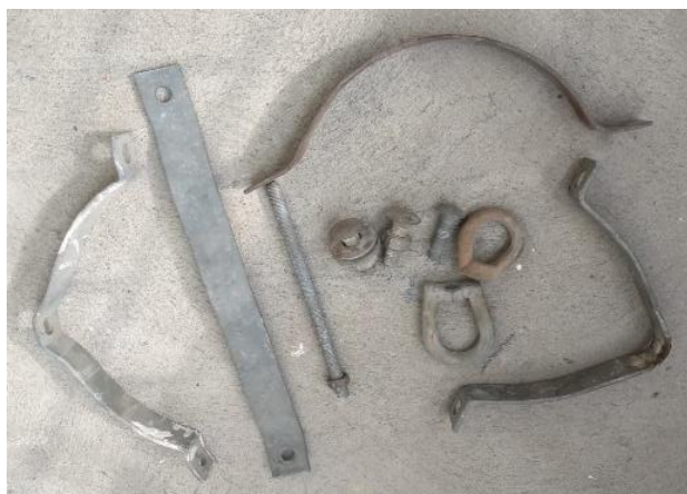
Figura 2. 11. Herrajes, abrazaderas, pie de amigo terminal de ojo, pernos
