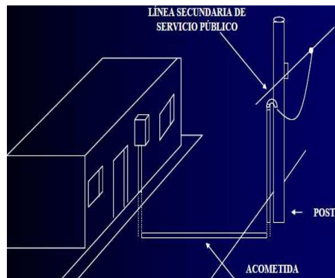
Figura 2.14 Acometida subterránea Fuente: (Martinrf, 2012)
