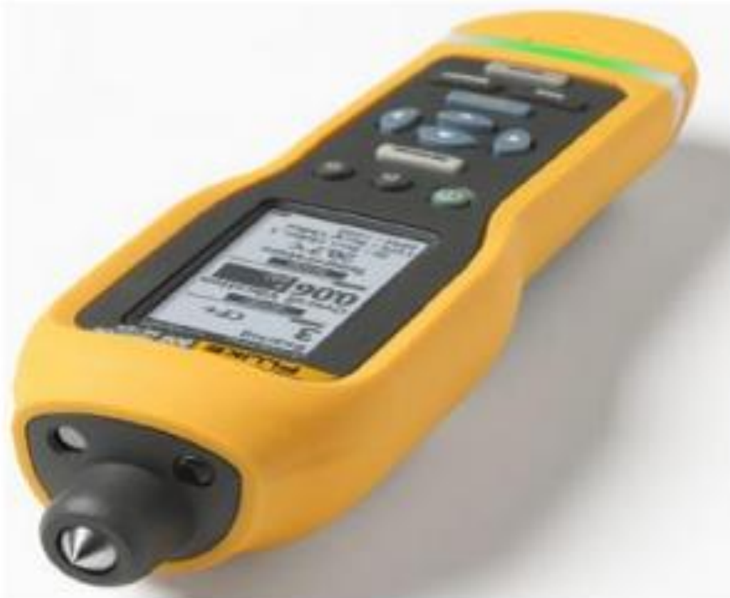
Figura 2.7: Equipo de medición de vibraciones Minimate – Instante. Fuente: (Gutierrez & Serna, 2014)
