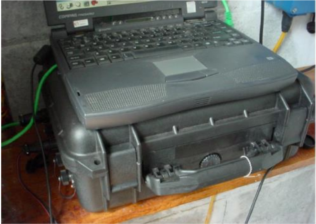
Figura 2.6: Equipo de medición de vibraciones de 0 a 5 V. Fuente: (Medicion, 2014)
