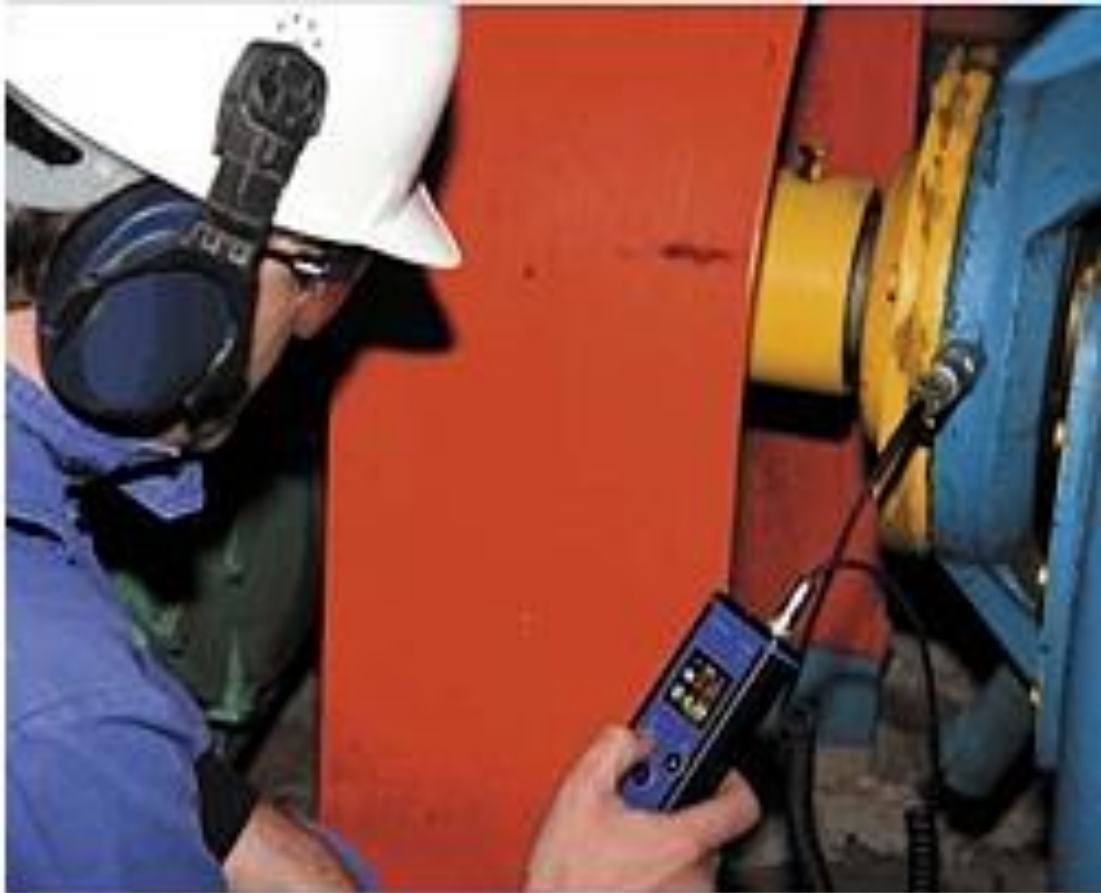
Figura 2.12: El vibrómetro PCE-VT 250D le permite diagnosticar el estado de sus máquinas y rodamientos Fuente: (PCE, 2016)
