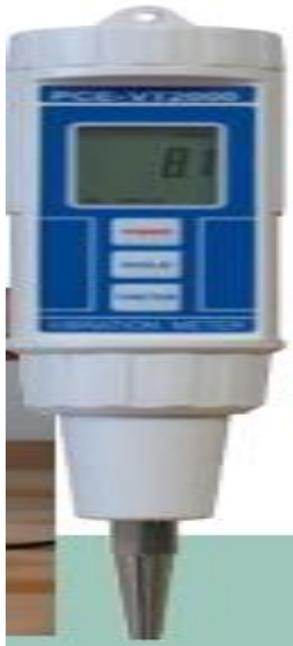
Figura 2.9: Vibrómetro para velocidad (RMS) y aceleración (PEAK) Fuente: (medidores, 2017)
