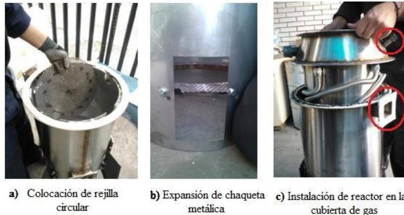
*Figura N° 13.1 Desmontaje de gasificador*
