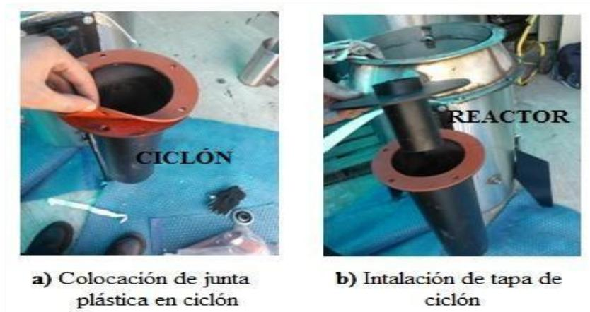
*Figura N° 25.1 Acoplamiento del ciclón*
