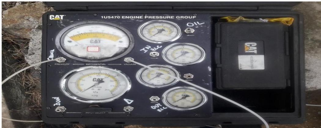
*Figura N° 33.1 Caja de evaluación de motores Caterpillar*
