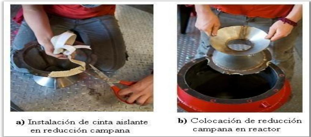
Figura N° 21.1 Instalación de campana
