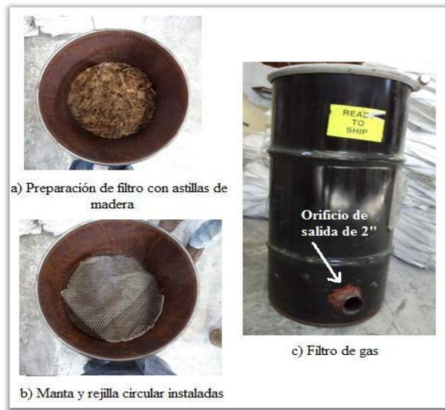
Figura N° 17.1 Tanque de filtro de humedad
