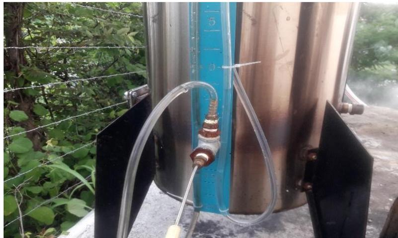
*Figura N° 30.1 instalación de manómetro en gasificador*
