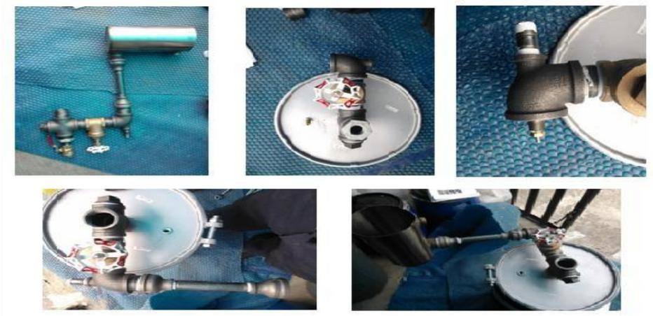
*Figura N° 27.1 Acoplamiento de eyector ventury*
