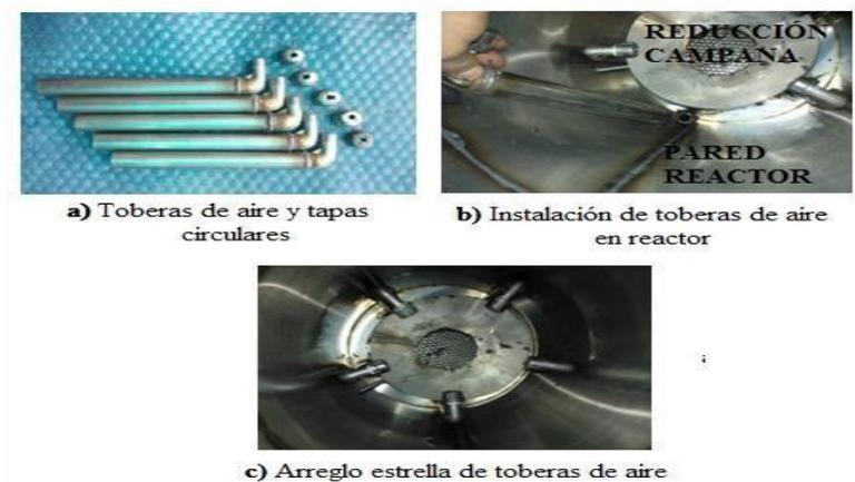
Figura N° 22.1 Boquillas de entrada de aire
