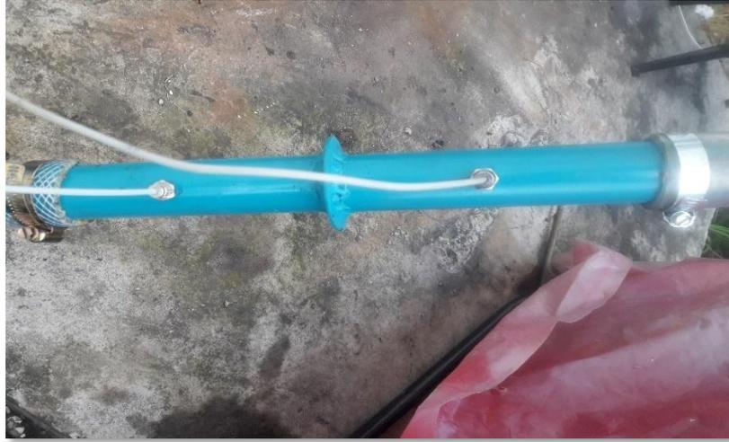
*Figura N° 32.1 Medidor de flujo de gas*
